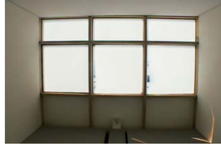
Abb. 5-6: TTV vollflächig im Fenster- und Überkopfbereich mit opaker Brüstung: Raumsituation (links) und horizontale Beleuchtungsstärkeverteilung in Arbeitshöhe (mitte) im Testraum, sowie Tageslichtquotient in der mittleren Raumachse von Test- (rot) und Referenzraum (Klarglas, blau) im Vergleich (rechts) beim Eintrübungsvorgang vom 22.07.00 um 09:00, 09:30, 10:00 und 10:30 (von oben nach unten, Situation 2). Horizontale Außenbeleuchtungsstärke 53918, 63662, 73100 bzw. 83068 lx, Orientierung 10° SSO.
