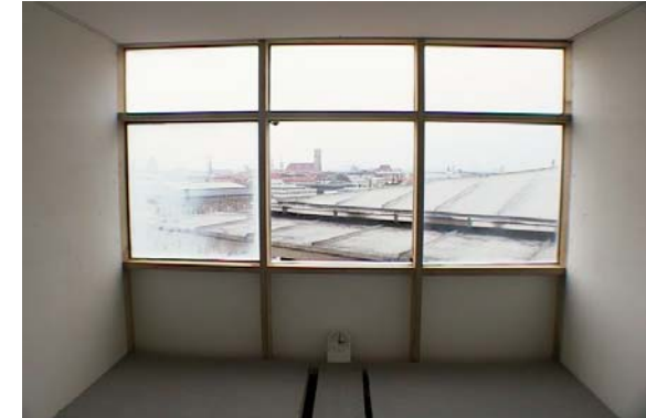
Abb. 5-46: Schlagartiges Aufklaren der vertikalen TTV durch plötzlich einsetzenden Regen, 23.07.00 um 15:01, Situation 2.
