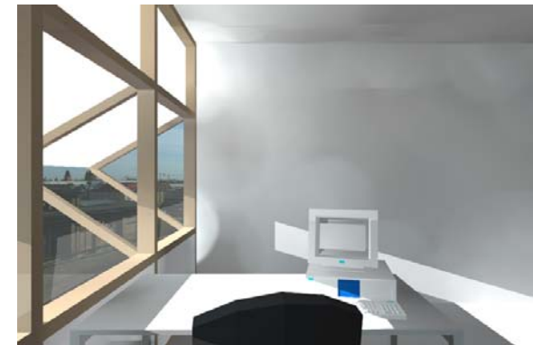
Abb. 5-34: TTV Oberlicht und 30° geneigte Auskragung: Visualisierung (RADIANCE) der Raumsituation am 21.12. um 9:00 mit transluzenter TTV, Südorientierung und Blickrichtung nach außen (oben) bzw. Blickrichtung auf den Bildschirmarbeitsplatz (unten).
