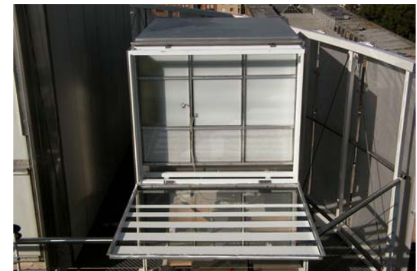
Abb. 6-10: Aufklappbare zweite Verglasungsebene mit beklebtem Glas und variierbarem Abstand zur inneren thermotropen Isolierverglasung. Die TTV ist innerhalb der TTV zum Fassadenzwischenraum (FZR) hin angeordnet.
