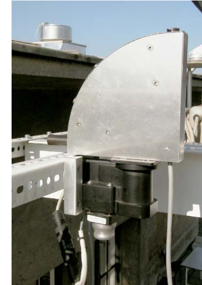
Abb. 4-16: Drehschrittmotor mit 5 Leuchtdichtefühlern zur Messung der Verteilung des Himmels
