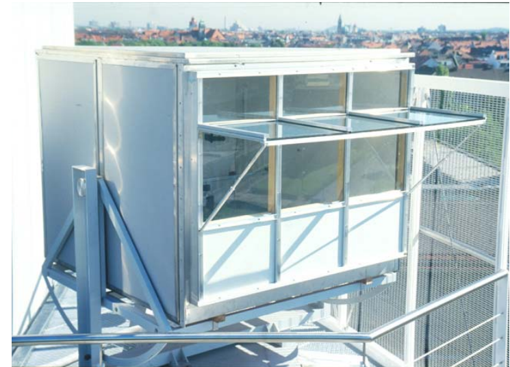
Abb.5-21: Außenansicht des maßstäblichen Testraumes bei den Versuchen mit Oberlicht und horizontaler Auskrragung aus TTV
