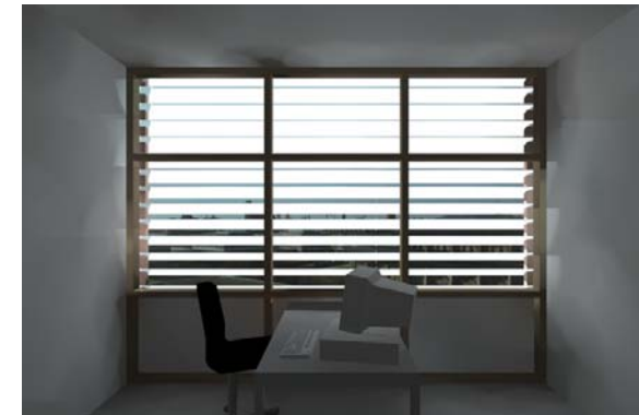
Abb. 5-36: Horizontale, drehbare TTV Lamellen als externer Überhitzungs- und Blendschutz auf einer südorientierten Bürofassade: Visualisierung (RADIANCE) der Raumsituation mit transluzenter TTV am 21.12. um 9:00 (oben) und 10:00 (unten). Verhältnis von Lamellenbreite zu -abstand 1:1, Lamellenwinkel -20^\circ .
