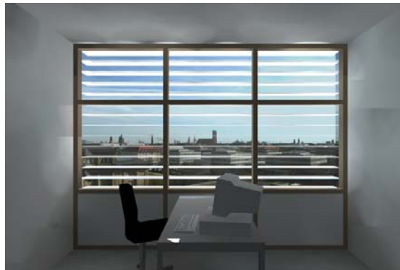
Abb. 5-35: Horizontale TTV Lamellen als externer Überhitzungs- und Blendschutz auf einer südorientierten Bürofassade: Visualisierung (RADIANCE) der Raumsituation am 21.9. um 10:00 mit transparenter TTV (oben), und transluzenter TTV (unten). Verhältnis von Lamellenbreite zu -abstand 2:1.
