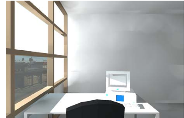
Abb. 5-20: Visualisierung (RADIANCE) der Raumsituation bei transluzenter TTV mit einem transparentem Fenster am 21. Dezember 12:00 mittags: Eine Blendwirkung ist bei dieser Arbeitsplatzanordnung nicht jederzeit auszuschließen.
