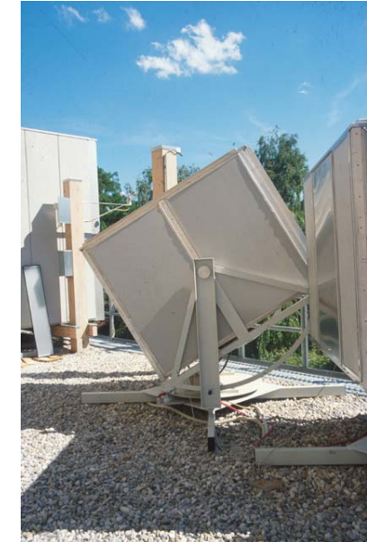
Abb. 4-6: Versuchsräume mit dreh- und schwenkbarem Stahluntergestell
