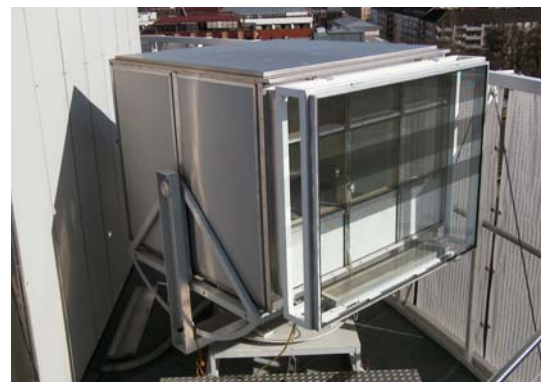
Abb. 6-13: Detail der Bedruckung (1:1), Darstellung der mit Streifenbedruckung ausgeführten Gläser von Interpane vor dem Hintergrund der Versuche und im eingebauten Zustand des Versuchsraums mit Doppelfassade (v.o.n.u.).
