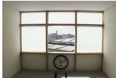
Abb. 5-18: TTV im Überkopf- und teillächig im Fensterbereich mit opaker Brüstung: Raumsituation (links) und horizontale Beleuchtungsstärkeverteilung in Arbeitshöhe von Testraum (mitte) und Referenzraum mit Streuglas (rechts) beim Versuch vom 31.07.2000 um 11:09, 12:48 und 15:07 (von oben nach unten). Horizontale Außenbeleuchtungsstärken: 30612, 119802 bzw. 100510 lx, Orientierung 10° SSO.
