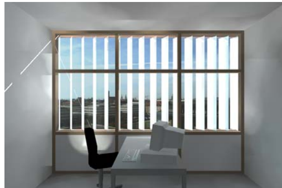
Abb. 5-37: Vertikale, drehbare TTV Lamellen als externer Überhitzungs- und Blendschutz auf einer südorientierten Bürofassade: Visualisierung (RADIANCE) der Raumsituation mit transluzenter TTV am 21.9. um 9:00 (oben), und 15:00 (unten). Verhältnis von Lamellenbreite zu –abstand 1:1, Lamellendrehung 30°.
