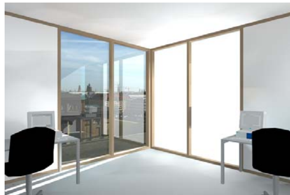
Abb. 5-40: TTV in der vertikalen Verglasung mit SO und SW Orientierung: Visualisierung (RADIANCE) des Effektes bei zeitlich versetzter Erwärmung am 21.9. um 10:00 (oben) und 21.9. 14:00 (unten) bei alternativer Arbeitsplatzanordnung.
