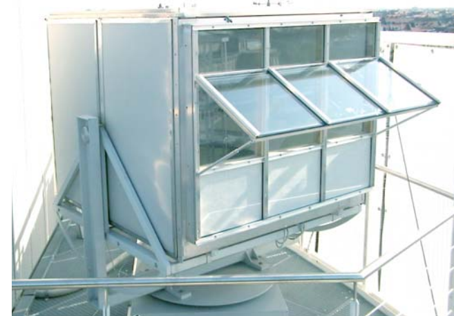
Abb. 5-22: Außenansicht des maßstäblichen Testraumes bei den Versuchen mit Oberlicht und 30° geneigter Auskrragung aus TTV
