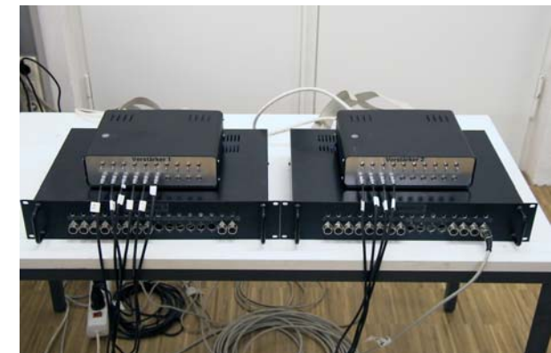
Abb. 4-18: Je zwei Messverstärker und Multiplexer zur Erfassung von Messdaten in Test- und Referenzraum.
