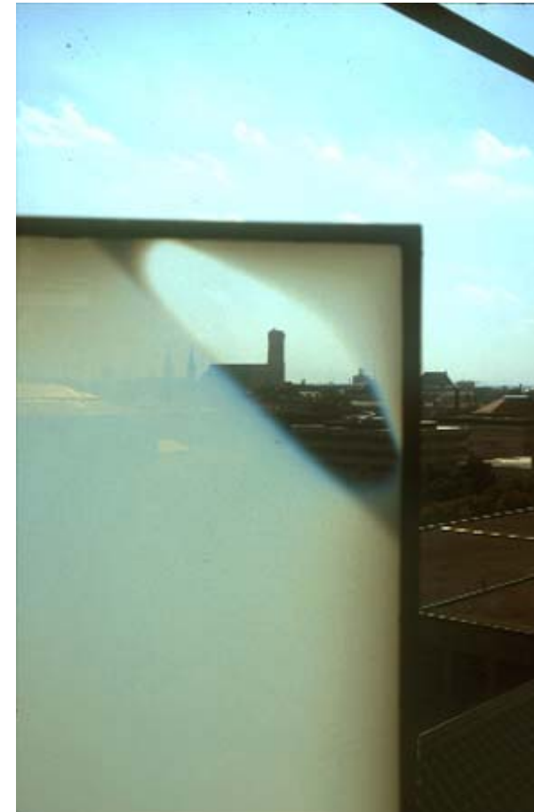
Abb. 6-1: Effekt des Schattenwurfes eines 30 mm Rundstabes auf eine freistehende TTV bei ca. 22°C Aussenlufttemperatur und sonnigem Wetter.
