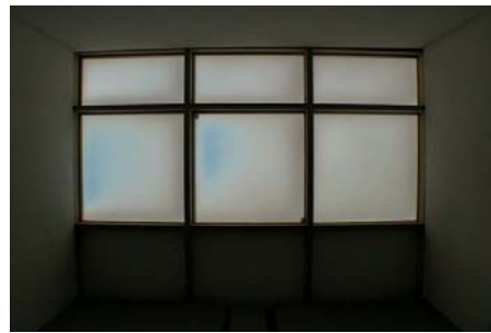
Abb. 5-5: TTV vollflächig im Fenster- und Überkopfbereich mit opaker Brüstung: Raumsituation (links) und horizontale Beleuchtungsstärkeverteilung in Arbeitshöhe (mitte) im Testraum sowie in der mittleren Raumachse von Test- (rot) und Referenzraum (Klarglas, blau) im Vergleich (rechts) beim Eintrübungsvorgang vom 02.11.1999 um 11:00, 11:05, 11:10 und 11:15 (von oben nach unten, Situation 1). Horizontale Außenbeleuchtungsstärken: 50279, 51870, 53209 bzw. 55422 lx, Orientierung: 24° SSW.
