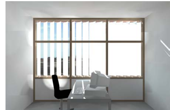
Abb. 5-38: Vertikale, drehbare TTV Lamellen als externer Überhitzungs- und Blendschutz auf einer südorientierten Bürofassade: Visualisierung (RADIANCE) der Raumsituation mit transluzenter TTV am 21.9. um 13:00 (oben), und 12:00 (unten). Verhältnis von Lamellenbreite zu –abstand 1.3:1, Lamellenwinkel 30° (oben) und 45°(unten).
