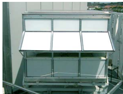
Abb. 5-27: Oberlicht und 30° geneigte Auskrägung aus TTV: Außenansicht während der Eintrübung (links), Raumsituation (Mitte) und korrespondierende, horizontale Beleuchtungsstärkeverteilung in Arbeitshöhe (rechts) beim Eintrübungsvorgang vom 02.08.2000 um 08:45, 08:55, 09:05 und 09:15 (von oben nach unten) auf der Solarstation. Horizontale Außenbeleuchtungsstärken: 47273, 50941, 53972, 57207 und 103.662 lx, Orientierung 10° SSO.
