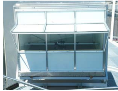
Abb. 5-23: Oberlicht und horizontale Auskrragung aus TTV: Außenansicht während der Eintrübung (links), Raumsituation (Mitte) und korrespondierende, horizontale Beleuchtungsstärkeverteilung in Arbeitshöhe im Testraum (rechts) beim Eintrübungsvorgang vom 01.08.2000 um 09:45, 09:55, 10:05 und 10:15 (von oben nach unten, Situation 2). Außenbeleuchtungsstärken: 67447, 70353, 73266 bzw. 75262 lx, Orientierung 10° SSO.
