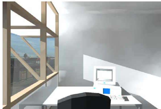
Abb. 5-33: TTV Oberlicht und horizontale Auskragung: Visualisierung (RADIANCE) der Raumsituation am 21.12. um 9:00 mit transluzenter TTV, Südorientierung und Blickrichtung nach außen (oben) bzw. Blickrichtung auf den Bildschirmarbeitsplatz (unten).
