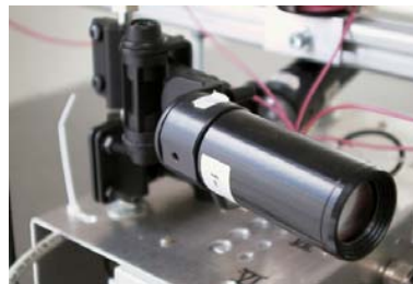
Abb. 4-14: Hagner- (oben) und Krochmann-Messfühler (unten) zur Messung von Beleuchtungsstärke und Leuchtdichte.
