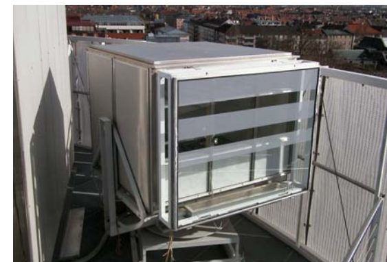
Abb. 6-13: Detail der Bedruckung (1:1), Darstellung der mit Streifenbedruckung ausgeführten Gläser von Interpane vor dem Hintergrund der Versuche und im eingebauten Zustand des Versuchsraums mit Doppelfassade (v.o.n.u.).
