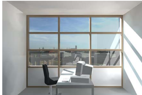
Abb. 5-19: Visualisierung (RADIANCE) der Raumsituation mit weiteren Möglichkeiten teilflächiger TTV-Belegung: TTV transparent (oben), 6 Felder mit transluzenter TTV (links) und 8 Felder TTV (rechts) bei unterschiedlichen Blickrichtungen (Fassade: mitte, Arbeitsplatz: unten), 21.09/10:00.
