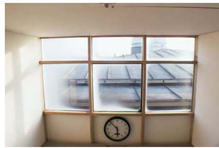
Abb. 5-10: TTV vollflächig im Fenster- und Überkopfbereich mit opaker Brüstung: Raumsituation (links) und horizontale Beleuchtungsstärkeverteilung in Arbeitshöhe (mitte) im Testraum sowie Tageslichtquotient in der mittleren Raumachse von Testraum (rot) und Referenzraum (blau) im Vergleich (rechts) beim Aufklärungsvorgang vom 26.09.2000 um 17:45, 17:48, 17:50 und 17:53 (von oben nach unten, Situation 2). Horizontale Außenbeleuchtungsstärken: 10794, 8464, 8747 und 9415 lx, Orientierung 24° SSW.
