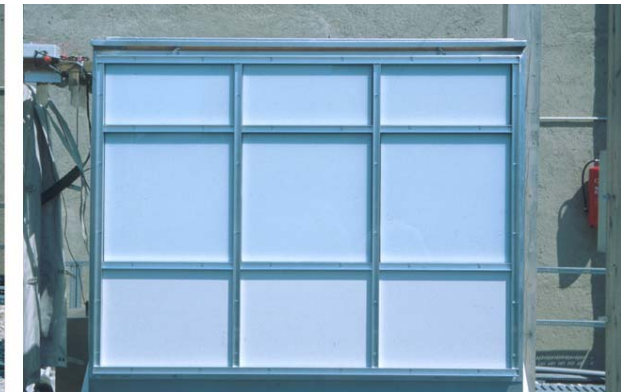
Abb. 4-7: Der maßstäbliche Versuchsraum mit opaker Brüstung nach Einbau der thermotropen Verglasung im Fenster- (Durchsicht-) und Überkopfbereich. Die TTV ist vollständig eingetrübt.
