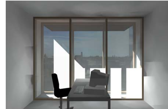
Abb. 6-4: Visualisierung (RADIANCE) des Effektes bei Beschattung der inneren thermotropen Verglasung durch eine Auskragung.
