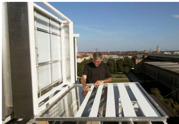
Abb. 6-10: Aufklappbare zweite Verglasungsebene mit beklebtem Glas und variierbarem Abstand zur inneren thermotropen Isolierverglasung. Die TTV ist innerhalb der TTV zum Fassadenzwischenraum (FZR) hin angeordnet.
