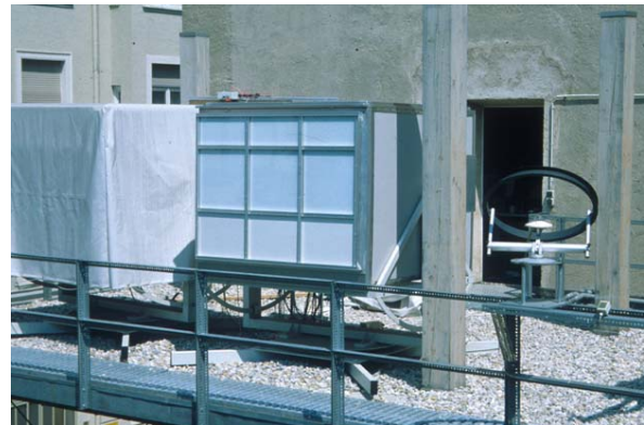
Abb. 4-7: Der maßstäbliche Versuchsraum mit opaker Brüstung nach Einbau der thermotropen Verglasung im Fenster- (Durchsicht-) und Überkopfbereich. Die TTV ist vollständig eingetrübt.
