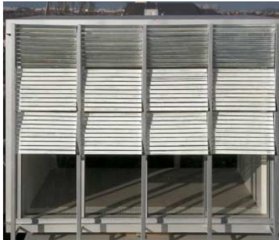
Abb. 5.13: CPC- Fassade, Modell 1:10, Außenansicht bei direktem Sonnenlichteinfall. Der Sichtwinkel liegt außerhalb im Akzeptanzbereiches der unteren Lamellenreihe.
