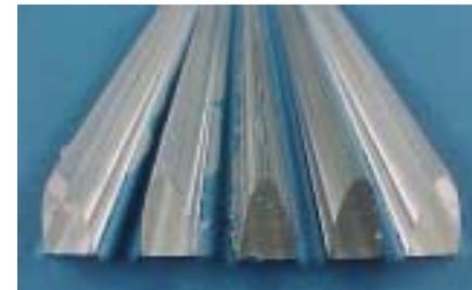
Abb. 5.4: Plangefräste Gießrohlinge (Positive) nach dem Auslösen aus der Stahlform
