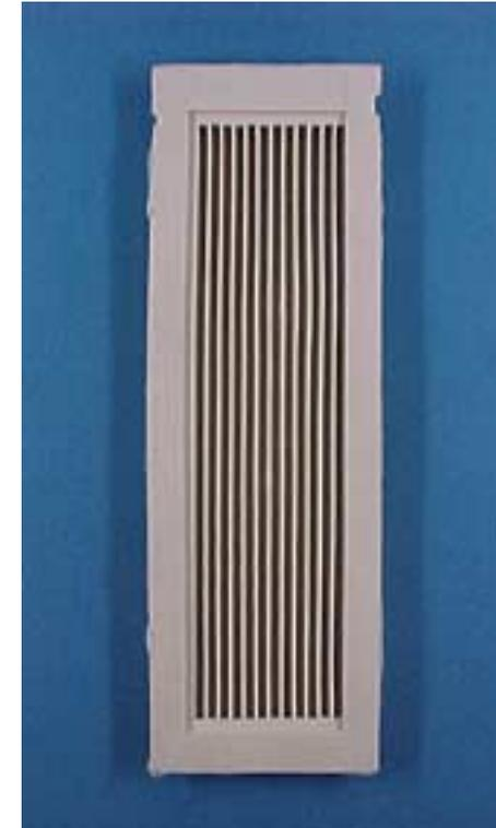
Abb. 5.3: Silikon- Negativform für Plattenabguß
