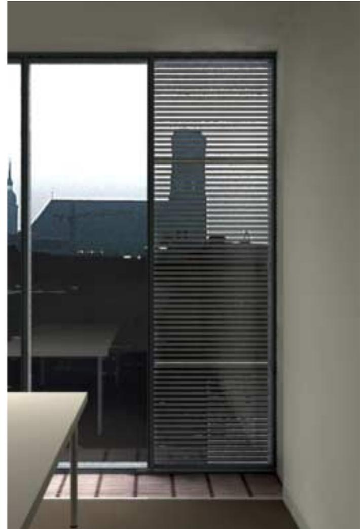
Abb. 3.58: Visualisierung der Innenansicht eines 25°/42°-CPC-Arrays. Der Brüstungsabschnitt liegt vom Betrachterstandpunkt aus im Winkelbereich der Teildurchsicht.
