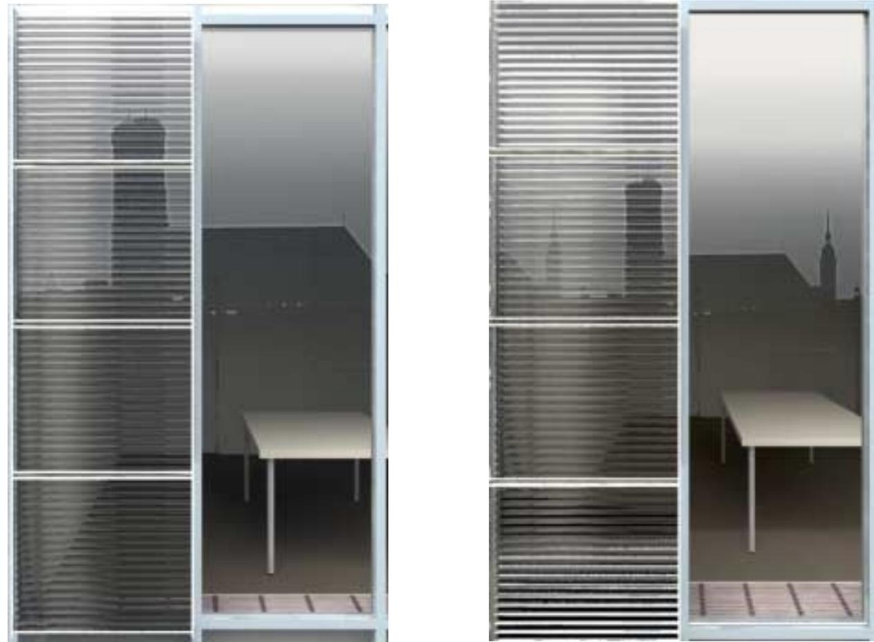
Abb. 3.54: Außenwirkung eines 25°/42°-CPC-Elementes mit opaken Zwischenflächen bei bedecktem Himmel für verschiedene Entfernungen zwischen Beobachterposition und Fassade. Bei Verkürzung der Distanz (r.) schließt sich die Fassade optisch von der Mitte nach oben und unten.
