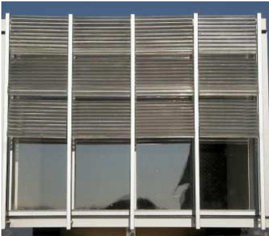
Abb. 5.12: CPC- Fassade, Modell 1:10, Außenansicht bei direktem Sonnenlichteinfall. Der Sichtwinkel liegt außerhalb des Akzeptanzbereiches.
