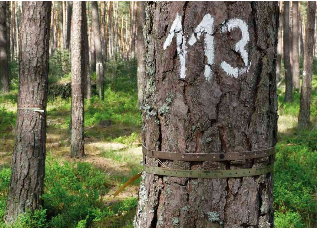
5 Dauerhaft angebrachte Umfangmessbänder ermöglichen die stetige Beobachtung der Durchmesserentwicklung und des Zuwachsverhaltens, ohne dass den Bäumen Jahrringbohrproben entnommen werden müssten.
