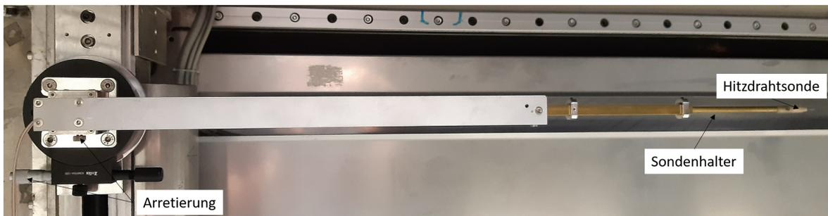
**Abbildung 4.7:** Sondenhalter mit montierter Hitzdrahtsonde
