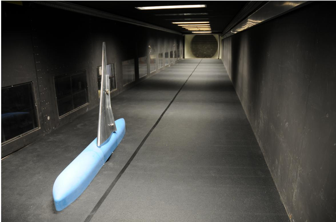
**Abbildung 4.8:** Windkanalmodell montiert in Windkanal C
