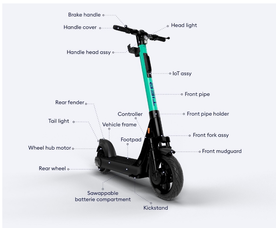
Abbildung 1: Aufbau und Bestandteile eines E-Scooters (mit freundlicher Genehmigung durch TIER Mobility)
