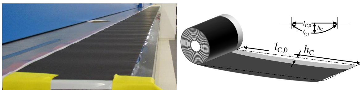
Abbildung 5-1: Abgewickelte Elektrode (links, Quelle: BMW AG) und Vorgehen zur Messung des Bandsäbels nach MÜCKE ET AL. (2002, S. 36) (rechts)
