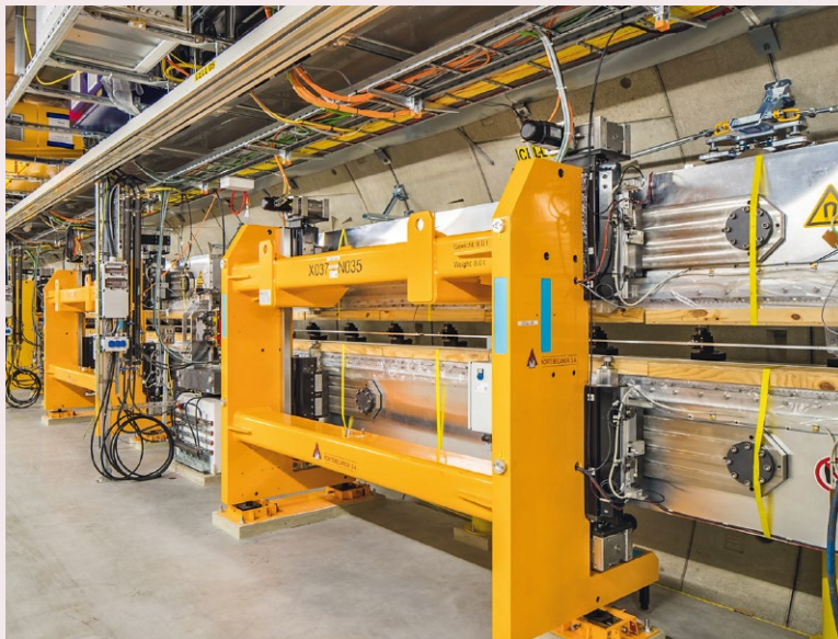
Undulatoren am European XFEL zur Erzeugung von intensiven, kurzen Röntgenpulsen (Bild: DESY/D. Nölle).
