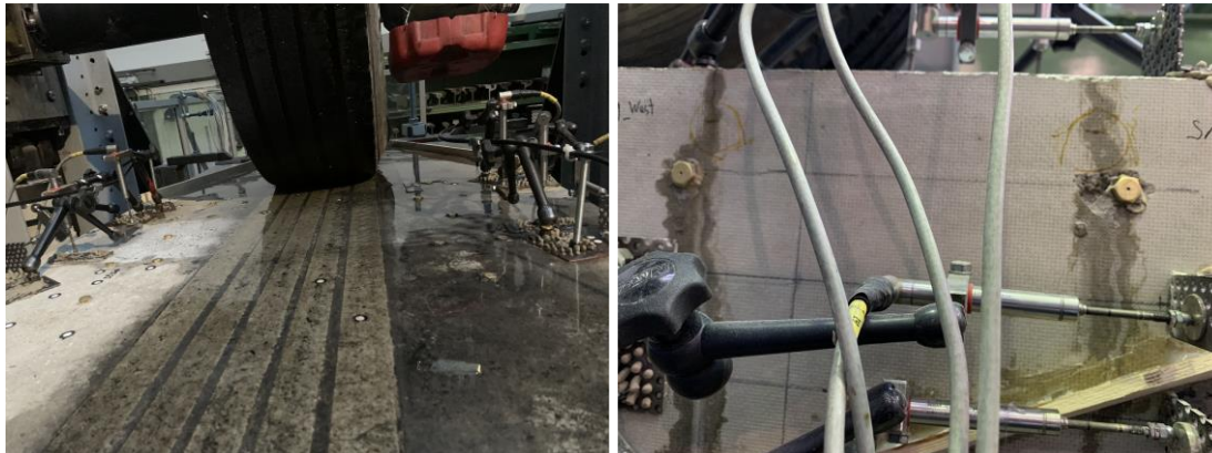
Abbildung B-16: Oberfläche Beregnung (links), Wasseraustritt im Rissbereich (rechts)
