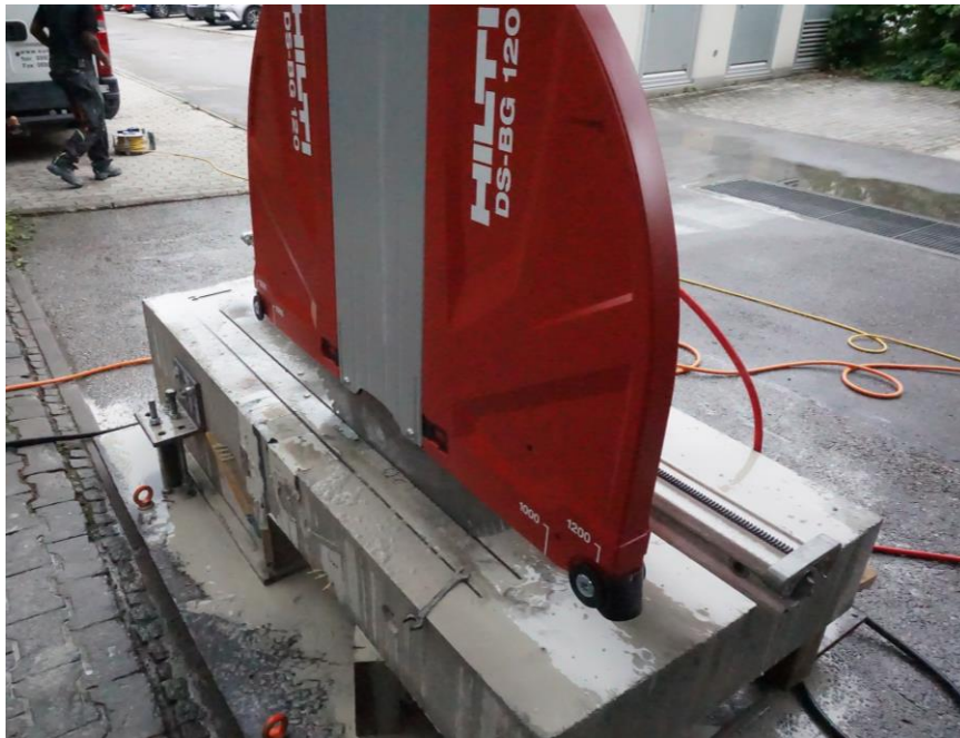
Abbildung B-20: Schneiden des Probekörpers in Segmente
