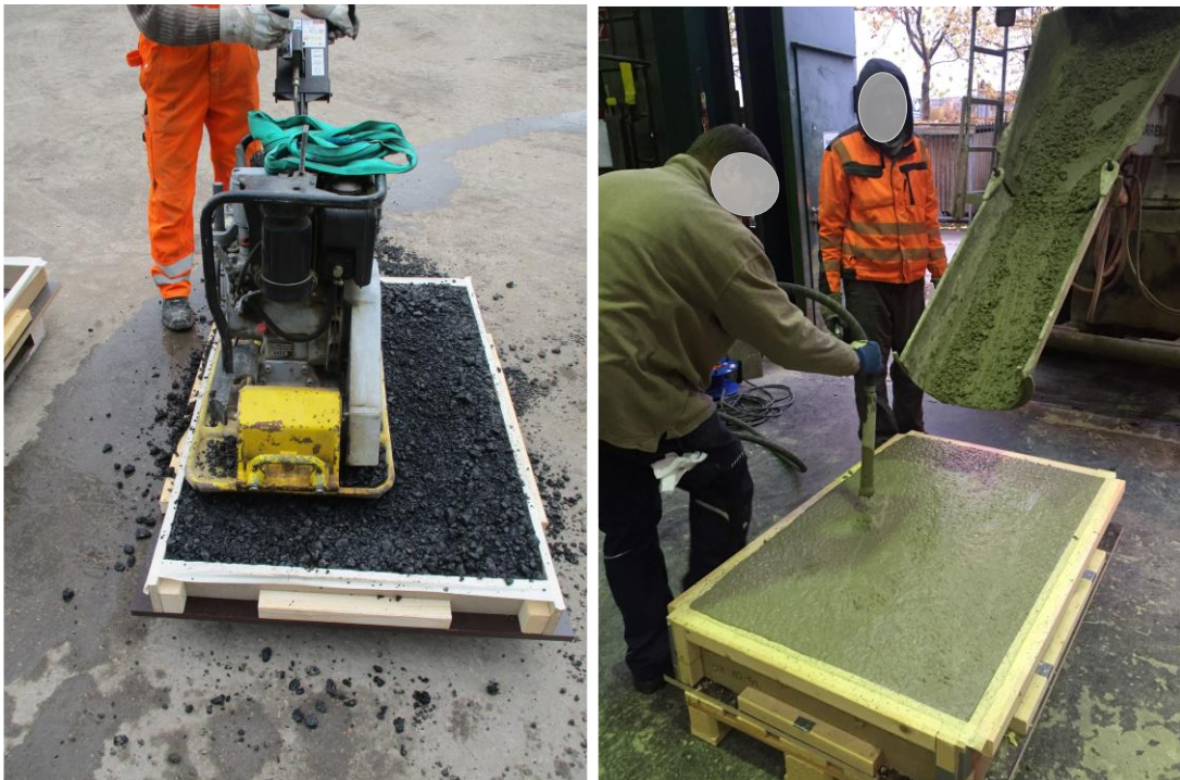
Abbildung A-2: Asphalteinbau AC 22 TS (links), Betonage Probekörper (rechts)
