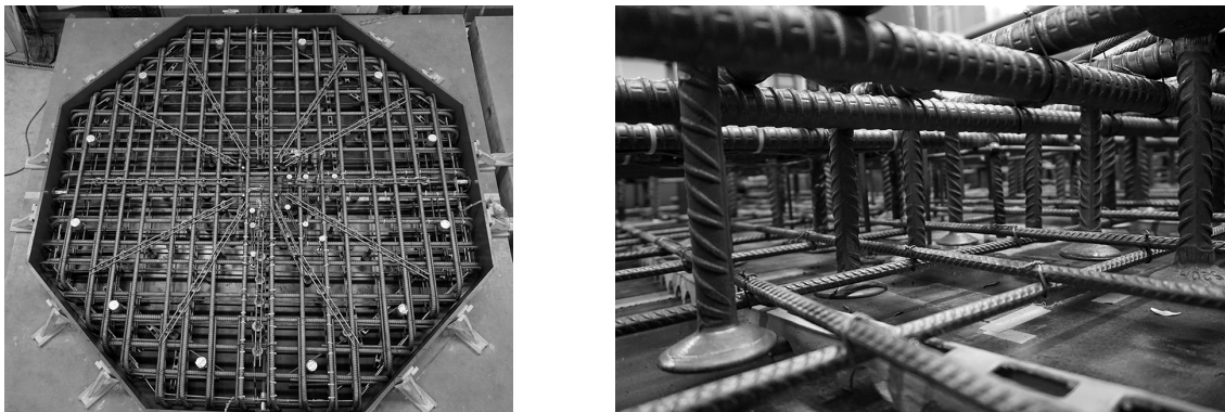
Bild 4.10: Anordnung bzw. Einbau der Doppelkopfbolzen in die Versuchskörper der Serie D
