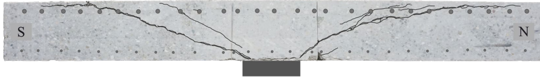
Bild A.92: Rissbilder der Trennschnitte 1 und 2 des Versuchskörpers M0-30-1.23
