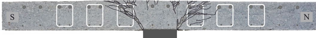
Bild A.139: Rissbilder der Trennschnitte 1 und 2 des Versuchskörpers M3-25-1.75-B8
