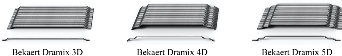
Bild 4.11: Stahldrahtfasern mit einfacher (links), eineinhalbfacher (Mitte) und doppelter Endhakenausbildung (rechts), zur Verfügung gestellt von Bekaert GmbH [Quelle: Bekaert GmbH]
