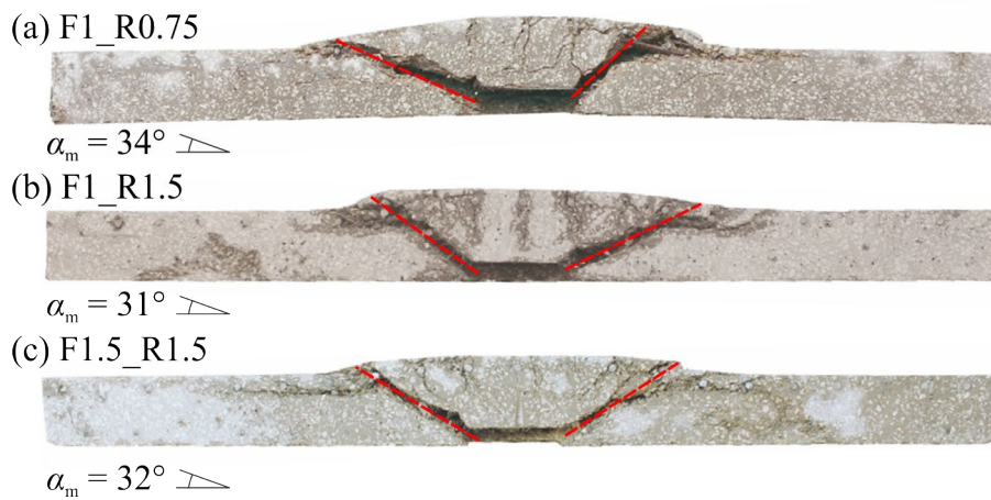
Bild C.10: Trennschnitte mit idealisierter Rissneigung der stahlfaserverstärkten Flachdeckenausschnitte nach GOUVEIA ET AL., entnommen aus [100]
