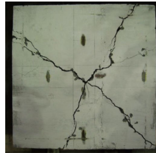
Bild 3.11: Rissbild der Plattenoberseite der mit unterschiedlichen Stahlfasergehalten und ohne Biegezugbewehrung ausgeführten Versuchskörper M44 und M48, entnommen aus [254]
