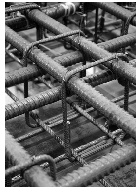
Bild 4.8: Einbau der Bügel als Durchstanzbewehrung in die Versuchskörper der Serie B
