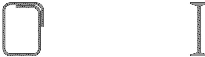
Bild 4.2: Schematische Darstellung der verwendeten Durchstanzbewehrung – geschlossene Bügel (links) und Doppelkopfbolzen (DKB) (rechts)
