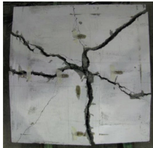
Bild 3.11: Rissbild der Plattenoberseite der mit unterschiedlichen Stahlfasergehalten und ohne Biegezugbewehrung ausgeführten Versuchskörper M44 und M48, entnommen aus [254]
