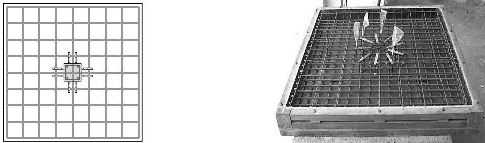
Bild 3.15: Skizze der balkenartigen Anordnung der Durchstanzbewehrung nach [283] (links) sowie Schalung mit radial verbauter Durchstanzbewehrung, entnommen aus [15] (rechts)
