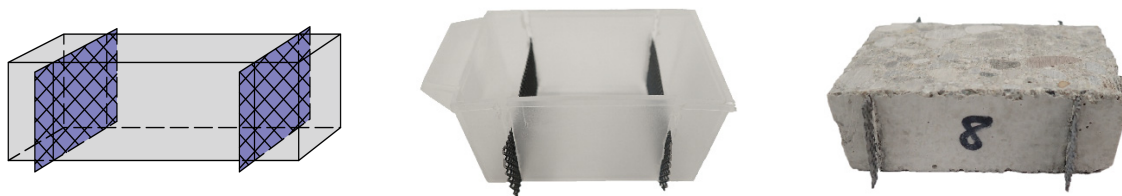
Abb. 12: Probekörper A; links: Zeichnung, Mitte: Schalung mit Einbauteilen, rechts: fertige Probe mit geschliffener Oberfläche
