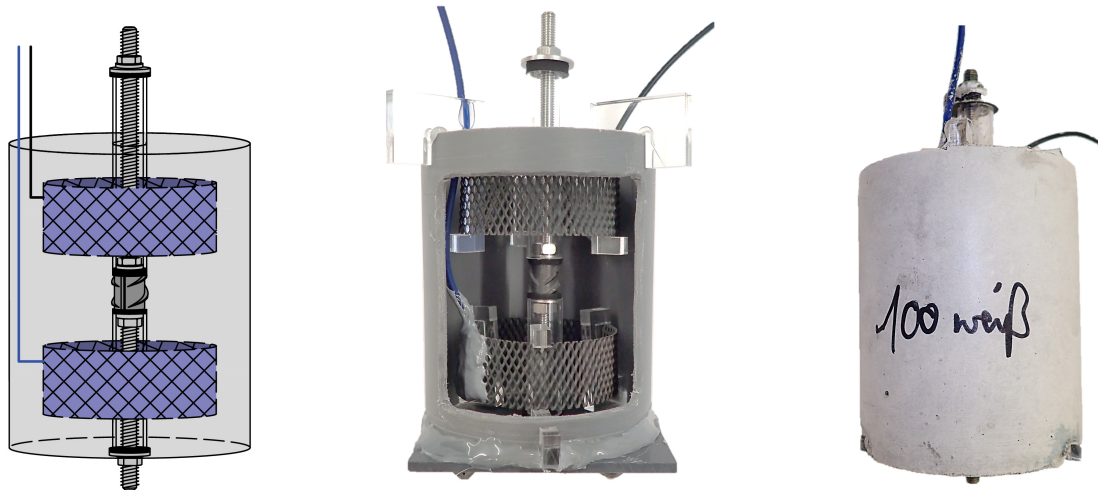
Abb. 14: Probekörper B; links: Zeichnung, Mitte: Schalung mit Einbauteilen, rechts: fertige Probe
