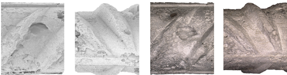
Abb. 26: Vergleich von gerenderten Aufnahmen mit Laserprofilometer (links) und Digitalmikroskopie (rechts) an einer Probe aus Serie I/0,5/2,5 – Versuchsreihe B
