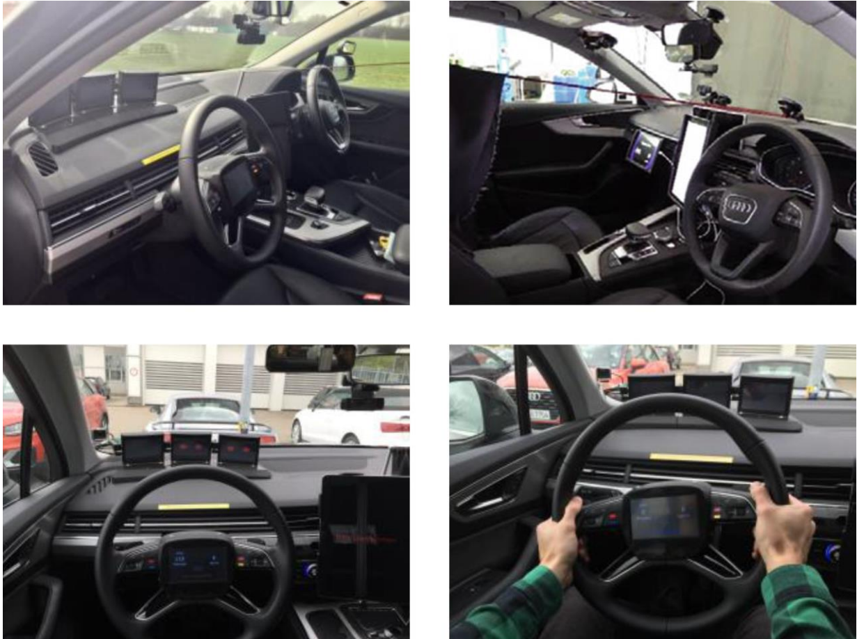
Abbildung 2-11: Wizard-of-Oz-Versuchsträger von Weinbeer et al. (2017; 2019)
