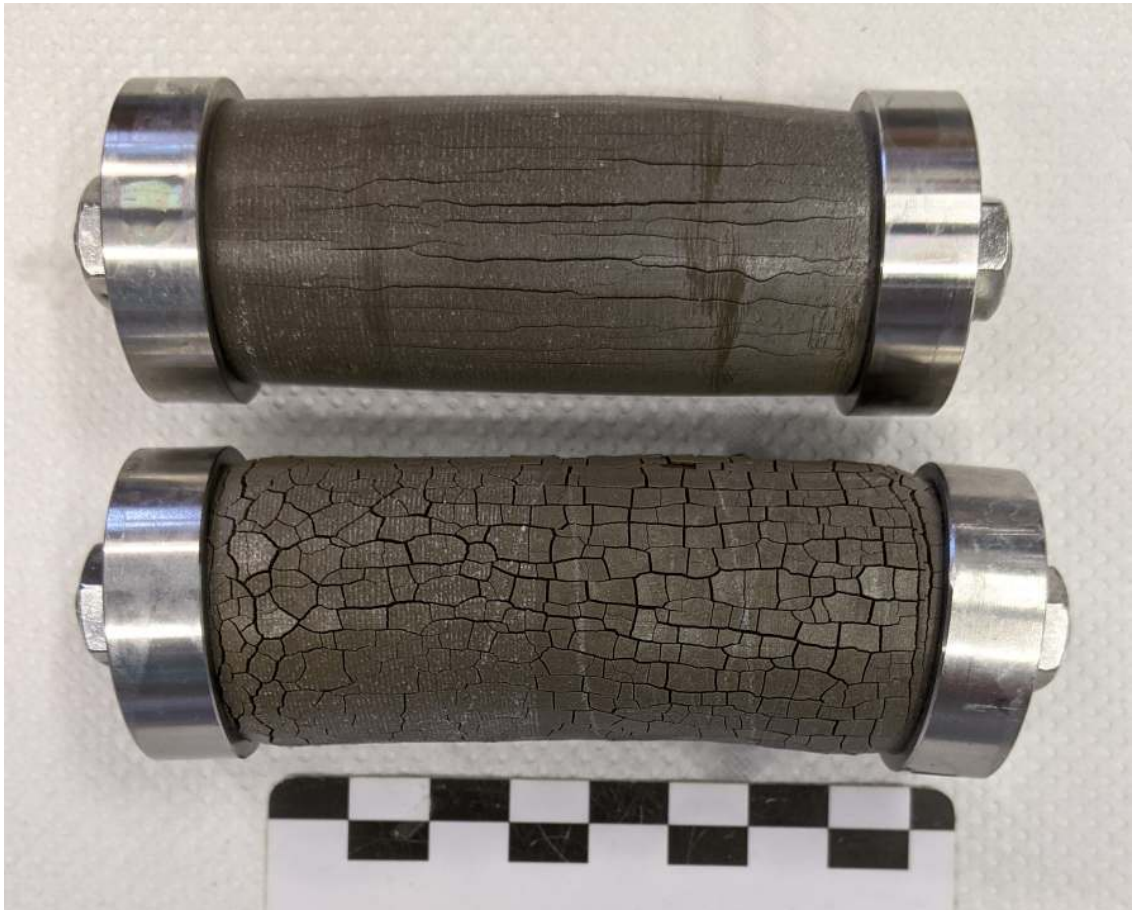
Abbildung 99 Zementsteinhohlzylinder aus PC L (Vorlagerung 28 d, w/b = 0,5) nach einer Lagerungsdauer von 81 d in Natriumsulfatlösung ( 30 \text{ g l}^{-1} \text{ SO}_4^{2-} ). Die Probe mit zusätzlicher Dehnungsbehinderung (oben) weist aufgrund der gehemmten Dehnung entlang der Längsachse vor allem Längsrisse auf. Das Rissbild unterscheidet sich dadurch von Proben ohne zusätzliche Dehnungsbehinderung (unten), welche durch die gleichmäßige Dehnung in alle Raumrichtungen ein netzartiges Rissmuster zeigen.
