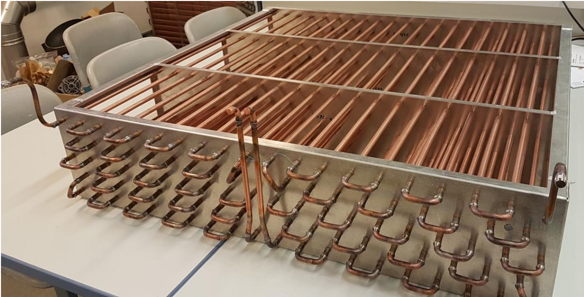
Abbildung 7-12: Versuchswärmeübertrager Demonstrator III.
