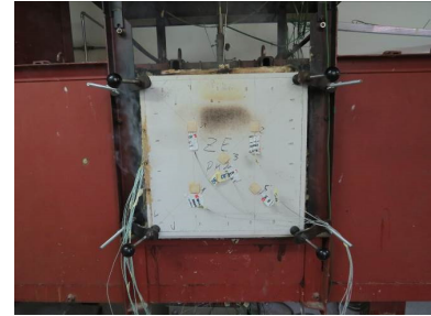
Abbildung 4-31: Teil- 8- Versuch ZF kurz vor dem Durchbrand
