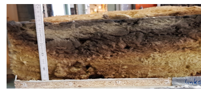
V7 b) Schnitt nach 120 min ETK- Beanspruchung
