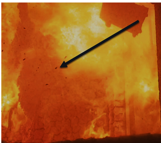
Abbildung 5-74: Versagen der Glaswolle im Versuch R1-V4-1m-GW-D nach Abs. 4.4.2 – Schmelzen der Glaswolle aus dem Deckengefach
