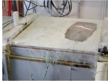
Abbildung 4-30: 1 m x 1 m Wand / Decke zum Zeitpunkt des Durchbrandes an der Decke im ZF-Gefach
