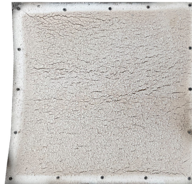
Abbildung 5-31: Rissbild einer Lage GKF (25 mm) hinterlegt mit einer 19 mm Spanplatte
