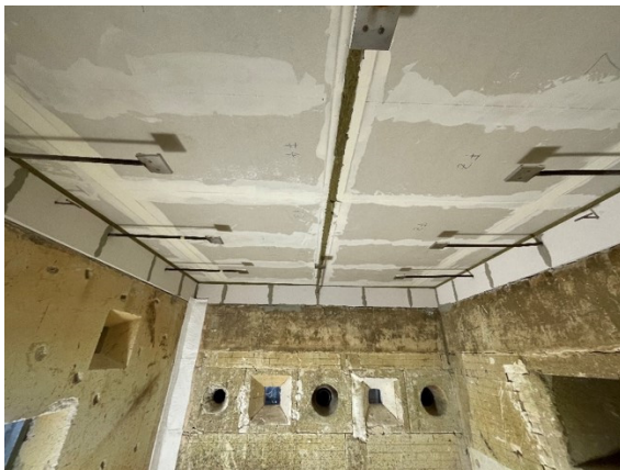
Abbildung 4-32: Deckenversuch, feuerzugewandt mit einer 18 mm GKF- Platte bekleidet
