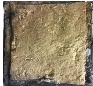
V7 a) Ansicht nach 120 min ETK- Beanspruchung
