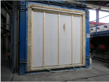
Abbildung 4-29: 3 m x 3 m Wand ZF/SW kurz vor dem Durchbrand im ZF- Gefach
