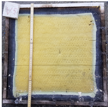
V5 a) Ansicht nach 103 min ETK- Beanspruchung
