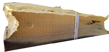
V6 b) Schnitt nach 103 min ETK- Beanspruchung
