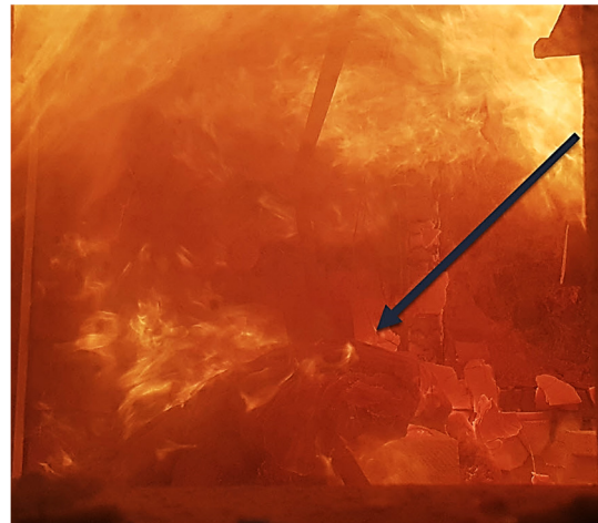
Abbildung 5-75: Versagen der Holzfaserdämmung im Versuch R1-V4-1m-HF-D nach Abs. 4.4.2 - Herausgefallene Holzfaserdämmung aus dem Deckengefach
