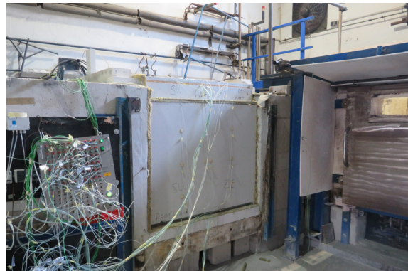
Abbildung 4-26: Brandprüfung - 1 m x 1 m Wand / Decke
