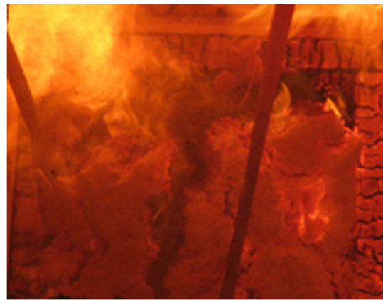
Abbildung 5-73: Versagen der Zelluloseeinblasdämmung (ZF) im Versuch R1-V3-1m-ZF-W nach Abs. 4.4.2 – schollenartiges Versagen der ZF im Wandgefach
