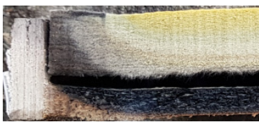
V5 b) Schnitt nach 103 min ETK- Beanspruchung
