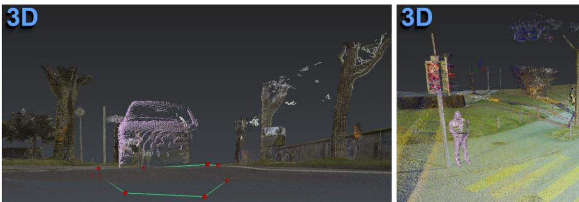
Abbildung 19: Auswahl nicht relevanter Objekte wie Fahrzeuge (links) und Passanten (rechts) zur Löschung in Leica Cyclone 3DR; eigene Abbildung.
