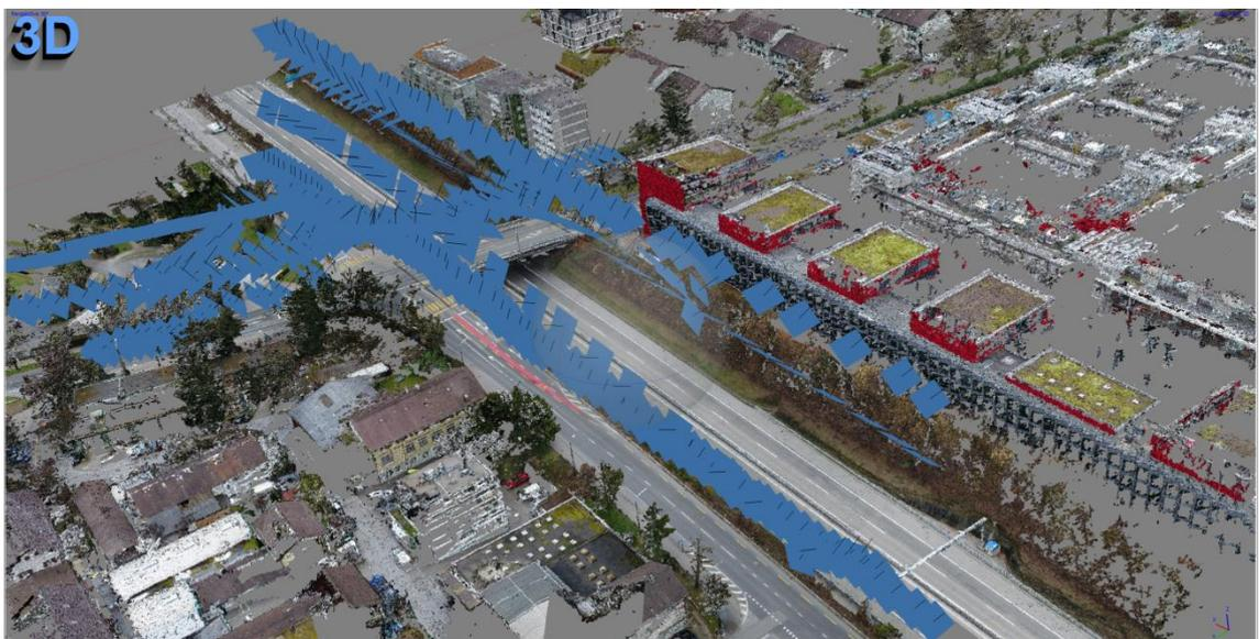
Abbildung 25: Schrägansicht von oben, dichte Punktwolke mit Kamerapositionen (blau) in Agisoft Metashape Professional; eigene Abbildung.
