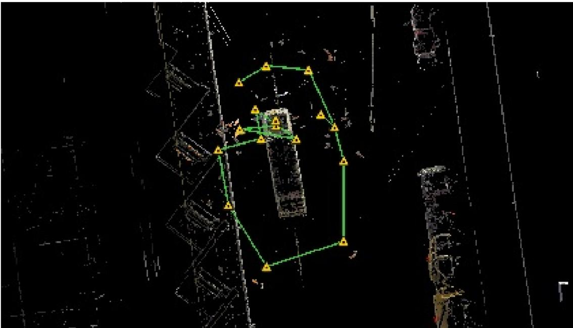
Abbildung 29: Ansicht von oben, Scanstandpunkte LKW mit Verknüpfungen in Leica Cyclone Register 360; eigene Abbildung.
