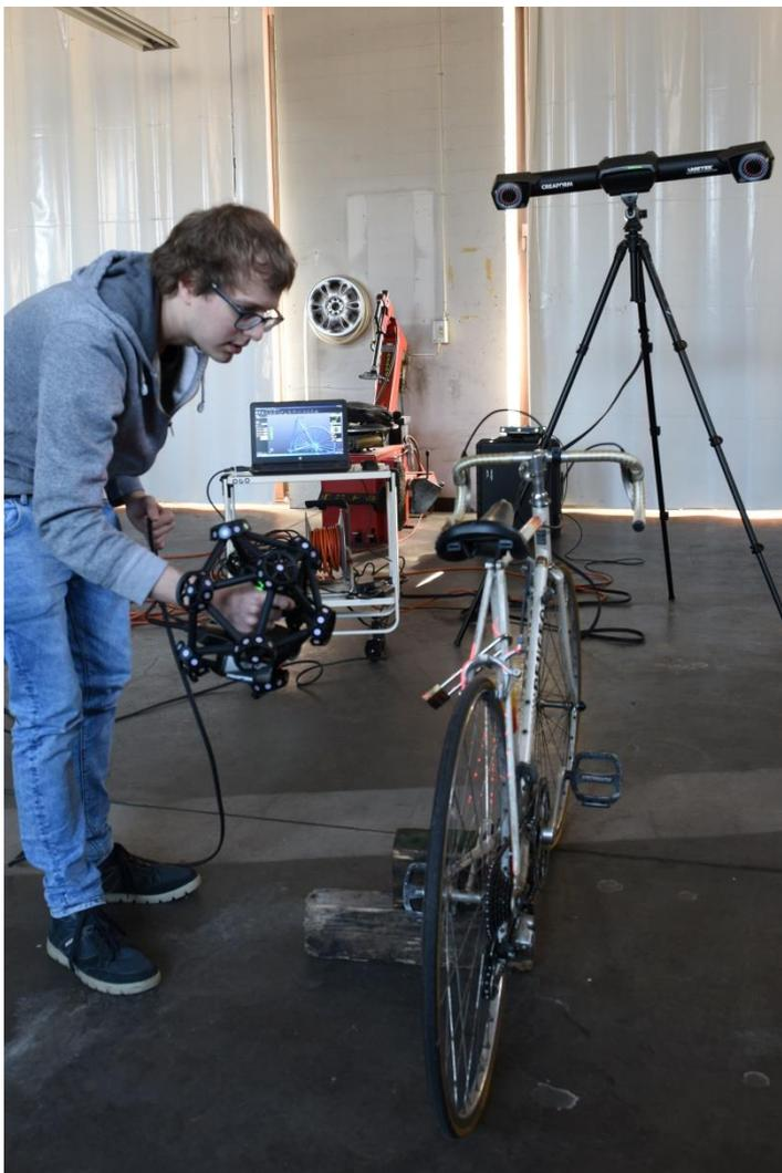
Abbildung 15: Metra SCAN 750 Elite, im Hintergrund C-Track auf Stativ; eigene Abbildung.
