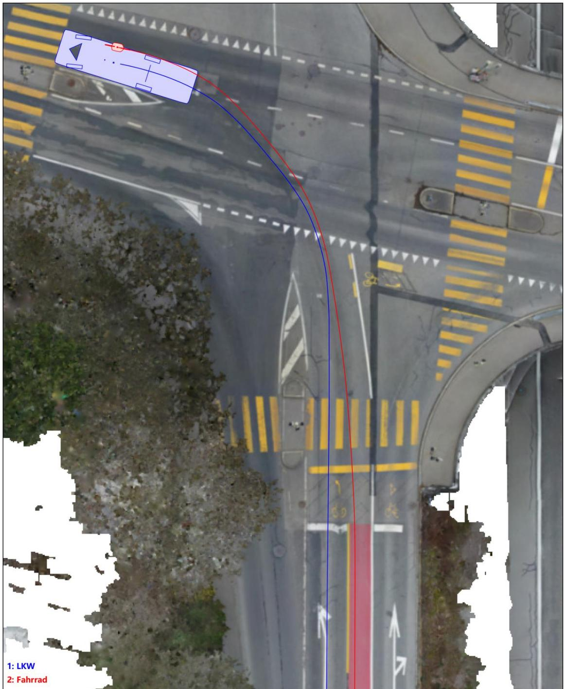
Abbildung 36:Exportierte Endposition und Pfad des LKWs (blau) und des Fahrrads (rot) aus Analyzer Pro eigene Abbildung.
