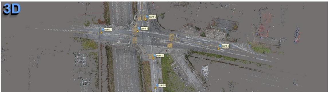
Abbildung 24: Ansicht von oben, Ausschnitt der dünnen Punktwolke mit Markierungen in Agisoft Metashape Professional; eigene Abbildung.
