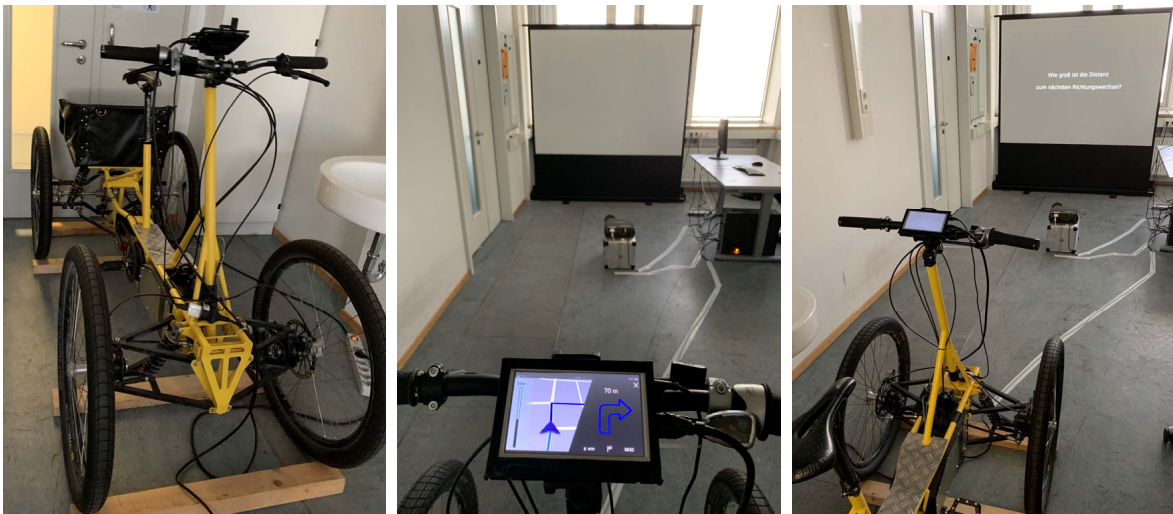
Abbildung 5.16: Versuchsfahrrad (links); Perspektive aus Sicht der Fahrenden mit eingeblenndem HMI (mitte); Darstellung der Fragen auf der Leinwand (rechts) (nach F. Winkler, 2020).
