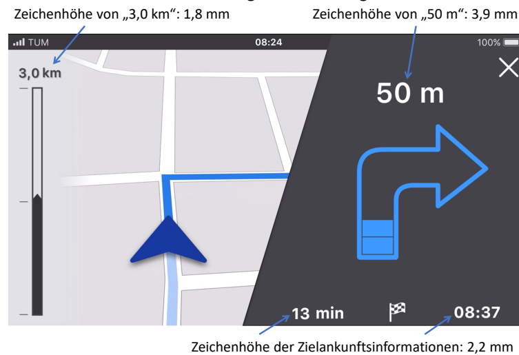
Abbildung C.6: Angaben zu den im Fahrrad-HMI unterschiedlichen Zeichenhöhen bei 50 cm Abstand vom Kopf zum Lenker auf einem 5" Display (nach Bandmann et al., 2019).
