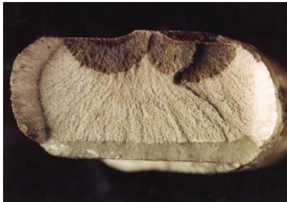
Abbildung 2.4: Bruchfläche eines Spannstahls infolge SpRK [Mietz1994]
