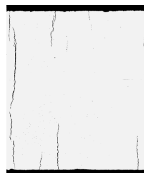
Abbildung 3.2: Anrisse am Spannstaahl: Probe abgebeizt (links) und Längsschliff (rechts) [Nürnberger & Beul1994]
