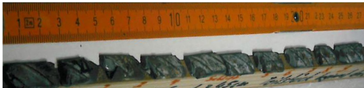
Abbildung 4.1: Durch Biegen erzeugte Brüche an den Anrissen eines Spanndrahtes [Müller1996]
