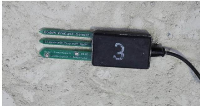
Abbildung A. 27: Foto eines Bodenanalysesensors (Aufnahme: Verfasser am 17.02.2020)
