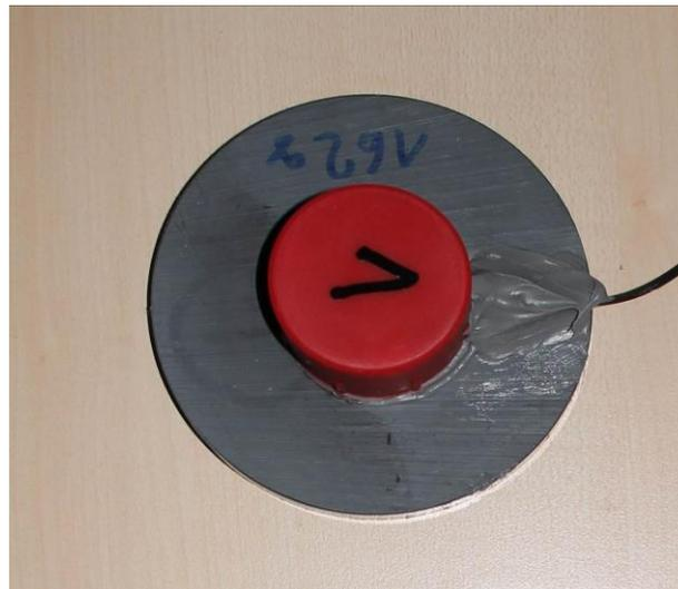
Abbildung A. 29: Schwingungssensor auf kreisförmiger Kunststoffplatte ( $d = 100 \text{ mm}$ ,  $H = 10 \text{ mm}$ ) für Messungen im Unterbau (Aufnahme: Verfasser am 05.07.2019)
