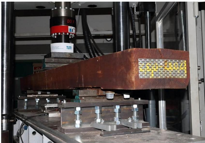
Abbildung A. 2: Versuchsaufbau des Dreipunkt-Biegeversuches in Schwellenmitte mit einer H250 Schwelle (Aufnahme: Verfasser am 26.11.2020)
