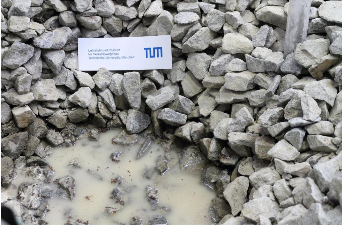
Abbildung A. 38: Stehendes Wasser auf dem Planum beim Ausbau des Versuches 2 (H250)
