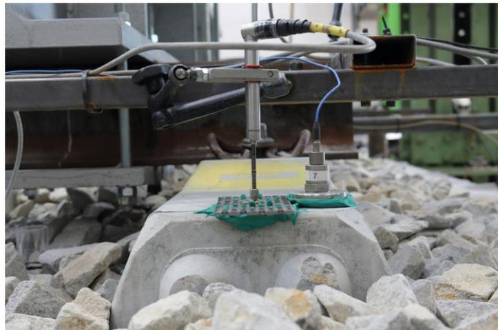
Abbildung A. 32: Induktiver Wegaufnehmer an einer Messbasis zur Messung der vertikalen Verformungen (links) sowie Beschleunigungssensor zur Messung des Schwingungsverhaltens (rechts) am Schwellenkopf (Aufnahme: Verfasser am 30.06.2020)
