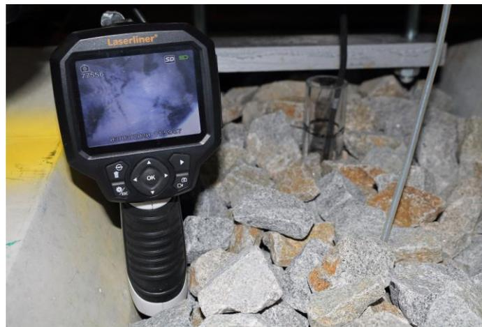
Abbildung A. 31: Endoskop zur visuellen Inspektion des Schotters und Unterbaus durch transparente Kunststoffrohre (Aufnahme: Verfasser am 03.03.2020)
