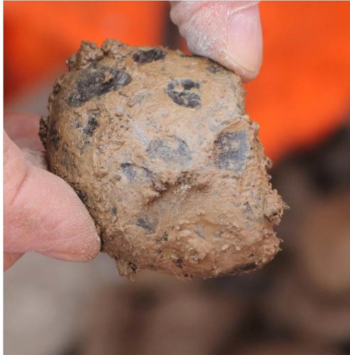
Abbildung 45: Verschmutztes Schotterkorn mit Druckstellen und Abplatzungen, entnommen unter der Schwellenunterseite (Aufnahme: Verfasser am 02.03.2020)
