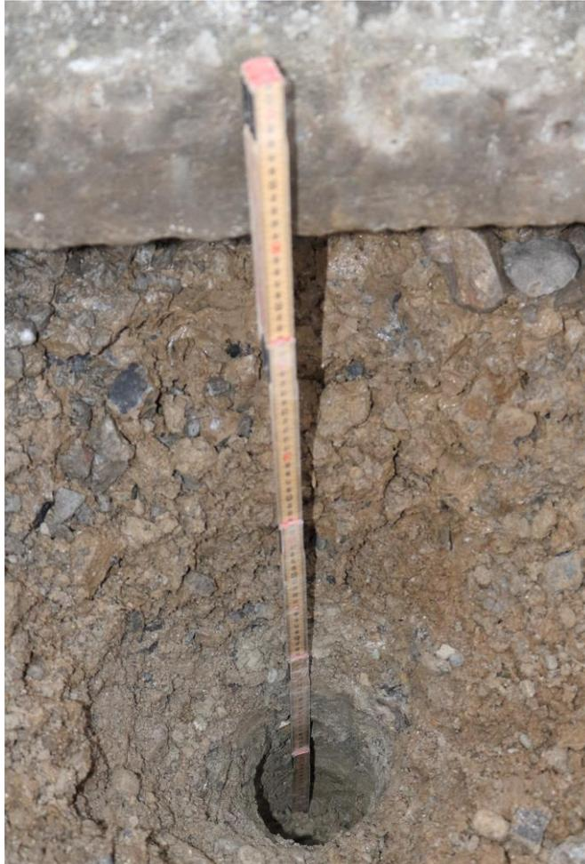
Abbildung 46: Es wurde bis zu einer Tiefe von ca. 0,9 m unter Schwellenunterseite sondiert. (Aufnahme: Verfasser am 02.03.2020)
