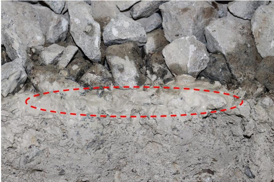
Abbildung 70: Verflüssigter Unterbau (Schlamm) im Bereich der Zwischenschicht exemplarisches Foto von Versuch 2 (H250) (Aufnahme: Verfasser am 05.06.2020)
