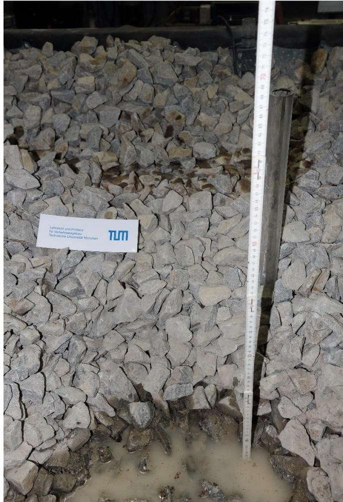
Abbildung 60: Querschnitt durch die Schotterbettung beim Ausbau des Versuches 2 (H250). Die dunklen Färbungen der Schotterkörner (durch Teeröl) im oberen Bildbereich zeugen vom Kontakt mit der Schwellensohlfläche. (Aufnahme: Verfasser am 05.06.2020)
