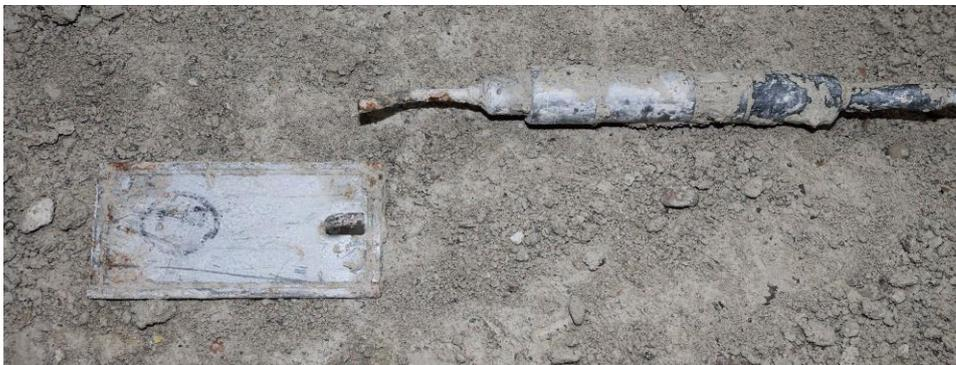
Abbildung A. 42: Foto eines beschädigten Bodendrucksenors beim Ausbau von Versuch 3 (B91 So). Der Schaft des Sensors ist während dem Versuch 3 gebrochen. (Aufnahme: Verfasser am 24.07.2020)
