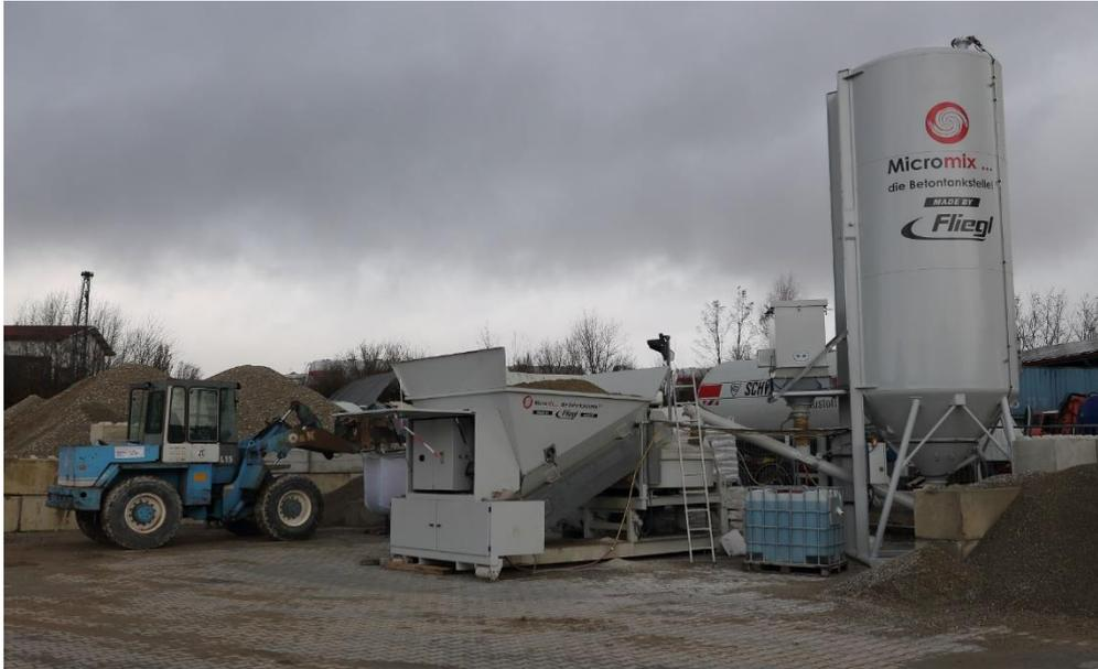
Abbildung A. 23: Betonmischanlage Hersteller Fa. Fliegl vom Typ Micromix zur Herstellung des TL40SK60 Korngemisches (Aufnahme: Verfasser am 11.02.2020)
