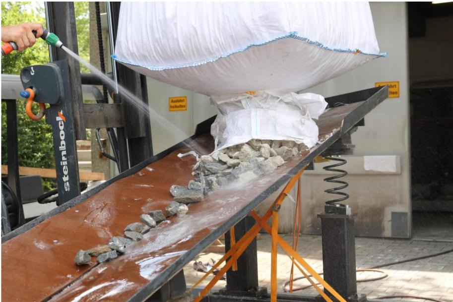
Abbildung A. 41: Schotterwaschanlage (Eigenbau TUM) zum Reinigen des Schotters der ausgebauten Zwischenschicht (Aufnahme: Verfasser am 28.07.2020)
