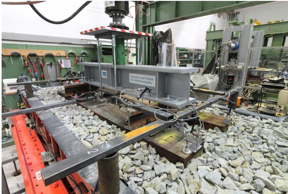
Abbildung A. 25: Sicht von oben auf den Versuchsaufbau des Versuches 2 (H250) (Aufnahme: Verfasser am 16.05.2020)
