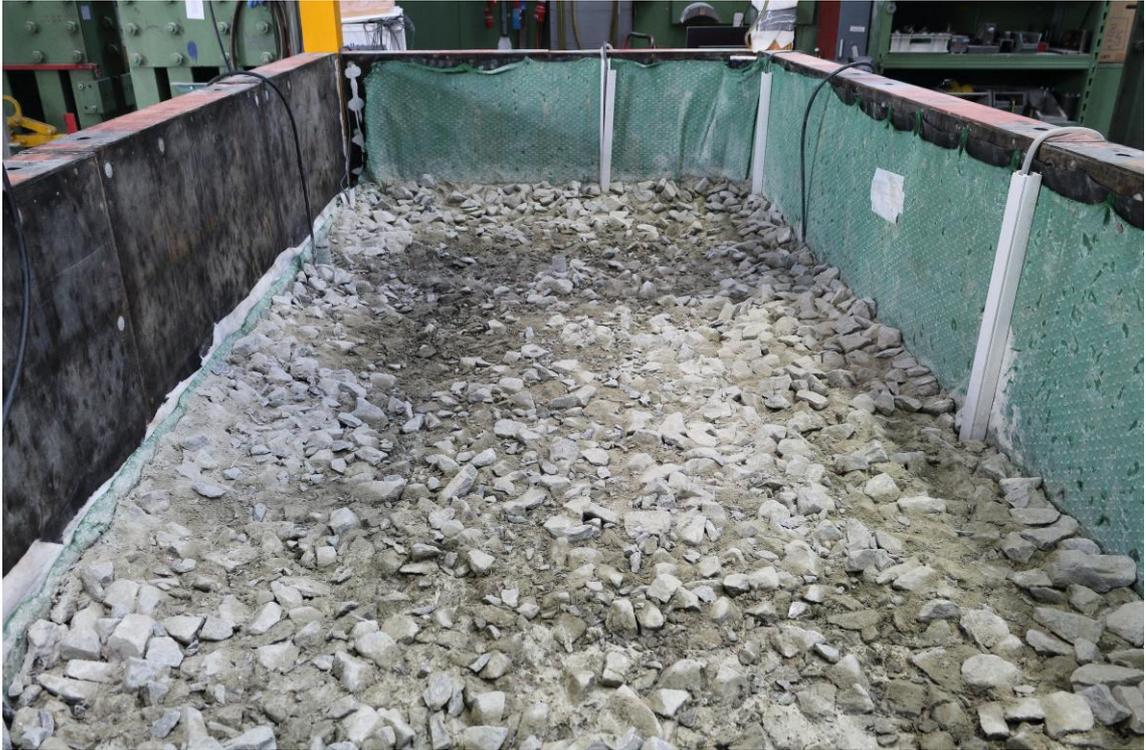
Abbildung A. 39: Loser Schotter vollständig ausgebaut beim Versuch 3 (B91 So) (Aufnahme: Verfasser am 22.07.2020)
