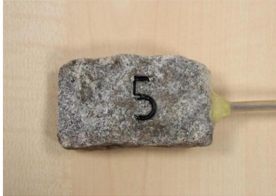
Abbildung A. 30: Schottermessstein mit integriertem Sensor zur Messung der Schwingbeschleunigung in der Bettung (Aufnahme: Verfasser am 11.02.2021)
