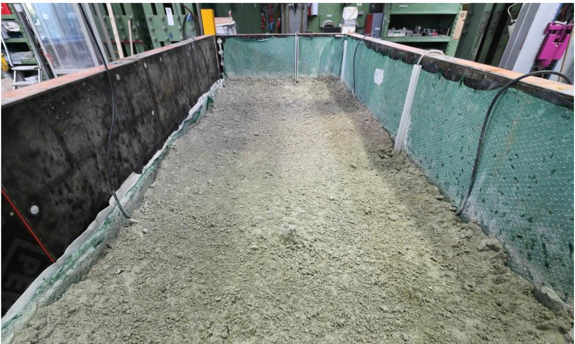
Abbildung A. 40: Schotter und Zwischenschicht vollständig ausgebaut beim Versuch 3 (B91 So) (Aufnahme: Verfasser am 22.07.2020)
