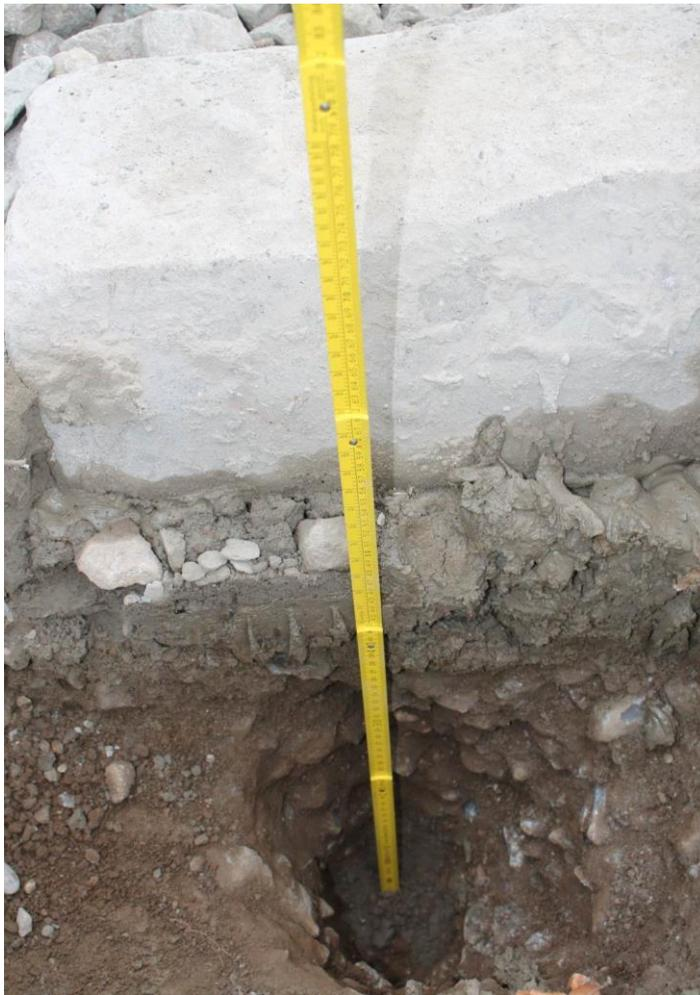
Abbildung 39: Foto des Handschurfes im Schwellenfach mit einer maximalen Tiefe von 55 cm unter der Schwellenunterseite. Deutlich hebt sich der Unterbau farblich vom Schlamm unter der Schwellenunterseite ab. (Aufnahme: Verfasser am 04.03.2019)
