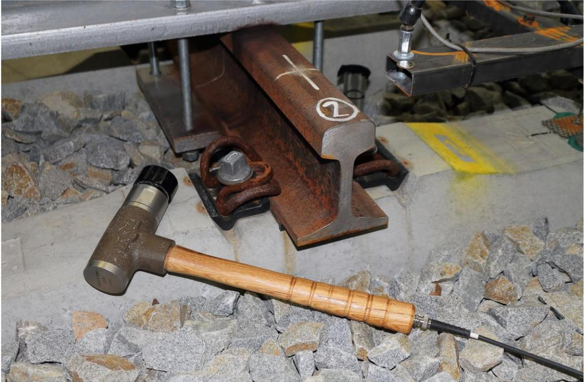
Abbildung A. 43: Impulshammer zur vertikalen Anregung der Gleisroste am Schienenkopf über den Stützpunkten zur Bestimmung der Übertragungsfunktion in den Unterbau (Aufnahme: Verfasser am 12.07.2020)
