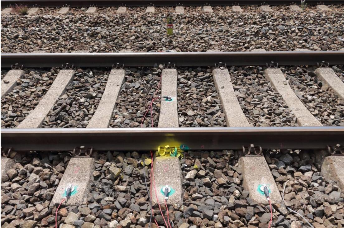
Abbildung A. 15: Messstelle bei den Betonschwellen (Aufnahme: Verfasser am 14.08.2019)
