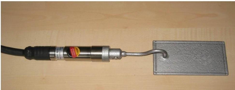
Abbildung A. 28: Foto eines Bodendruckensors, die Druckfläche beträgt 140 mm x 70 mm (Aufnahme: Verfasser am 06.05.2020)
