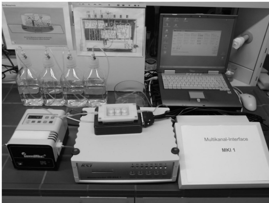
Abbildung 33: Ein Multikanal-Interface zur multiparametrischen Messung in sechs verschiedenen Probekammern [233].
