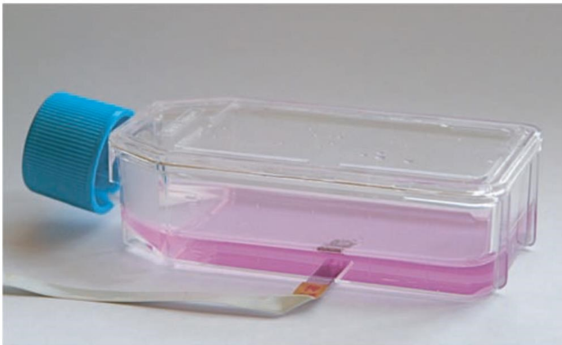
Abbildung 7: Eine Zellkulturflasche ausgestattet mit einem Sensorelement für die Sauerstoffmessung. Hierzu wurde eine Öffnung in eine Standardflasche geschnitten und der Sensor mit biokompatiblen Kleber dicht eingeklebt [60].
