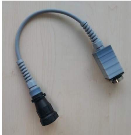
Abbildung 15: AP/PA Switch (Munich School of BioEngineering, Technische Universität München): Ermöglicht die Umkehrung der Sinusfunktion und somit der Stromflussrichtung.
