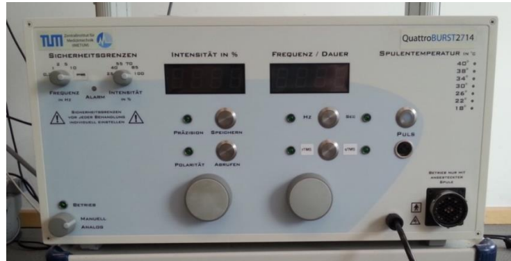
Abbildung 17: QuattroBURST 2714 (Munich School of BioEngineering, Technische Universität München): Stimulator, der repetitive Magnetstimulation mit biphasischen Pulsen und doppelter Sinusvollwelle erzeugt.
