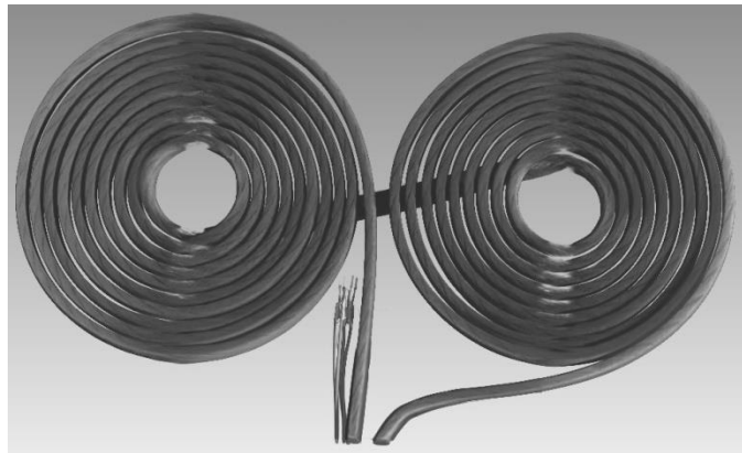
Abbildung 19: Rekonstruktion der Spule nach Computertomographie (zur Verfügung gestellt durch die Munich School of BioEngineering und Dr. Klaus Achterhold, Technische Universität München)
