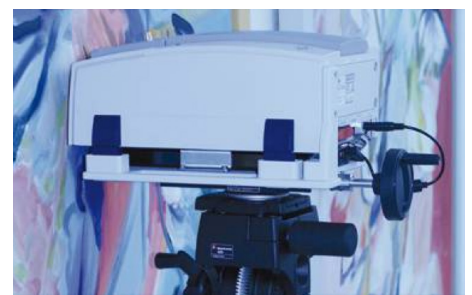
Abb. 3: Bruker Modell Alpha, Einheit für externe Reflexion, Rechts im berührungslosen Einsatz an einem Gemälde (Abb. Fa. Bruker)
