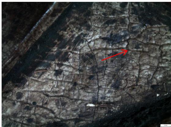
Abb. 28 Schleifspuren auf Grundierung
