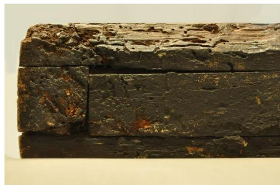
Abb. 46 Bügelzapfen T-Verbindung, Seitenansicht
