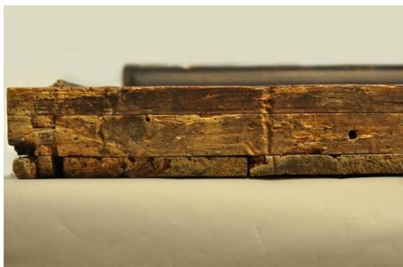
Abb. 45 Bügelzapfen T-Verbindung, Untersicht
