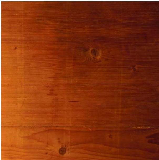
Abb. 140: Schmale „Prägestreifen“ sind in die Innenseite des Truhendeckels gedrückt. Deckeldetail, Truhe 13.
