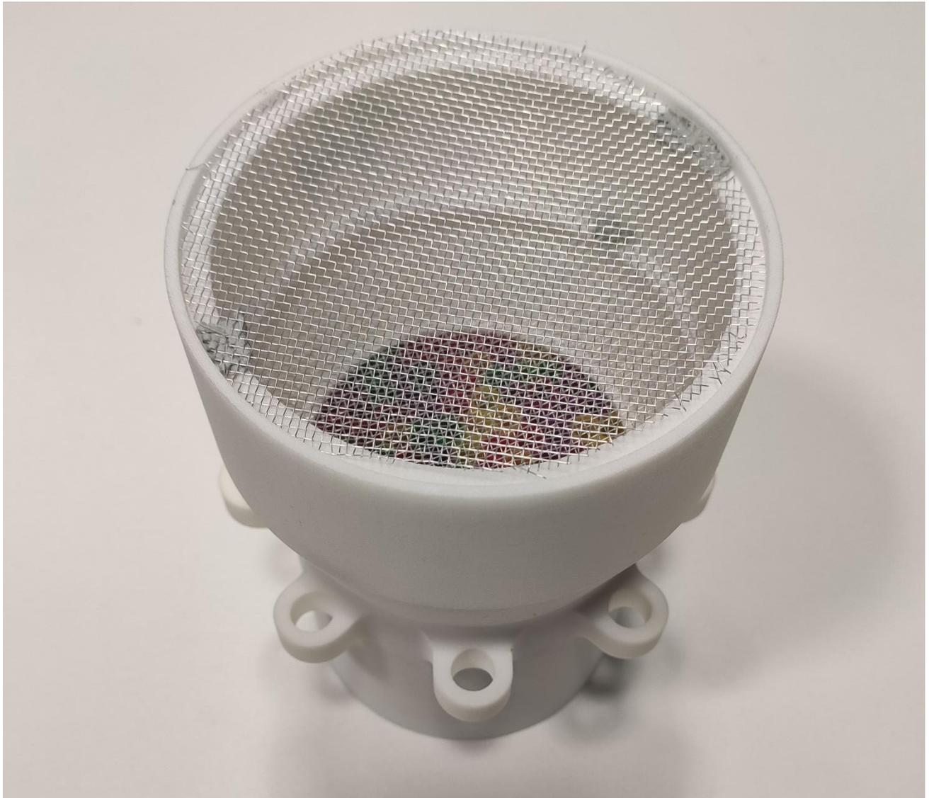
**Abbildung 21. Strömungsgleichrichter**
