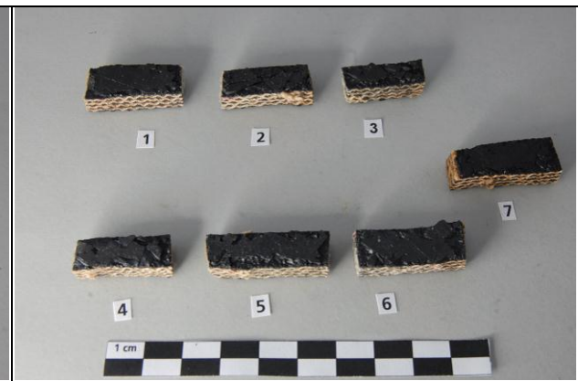
Foto 77: Proben Treibriemen 1-6, 48 h UV-bestrahlt
