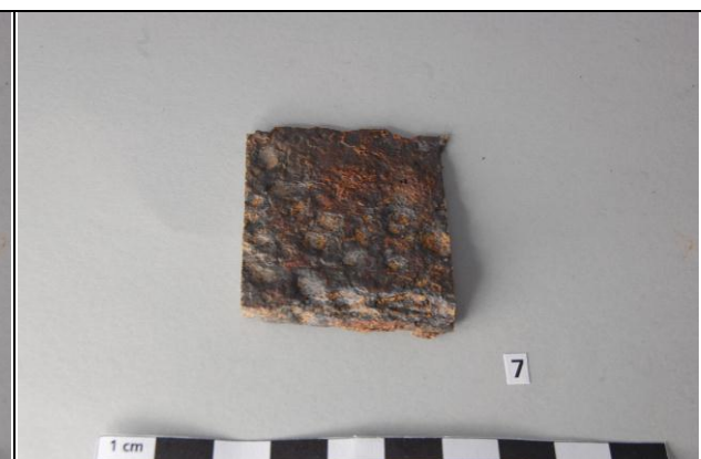
Foto 163: Fragment Sax P7 nach der Schichtentfernung mittels Feinstrahlen - Rückseite
