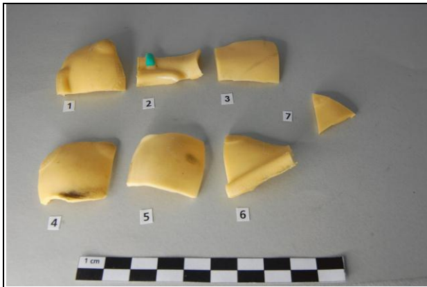
Foto 82: Proben PVC-Spielzeug 1-6, 24 h UV-bestrahlt
