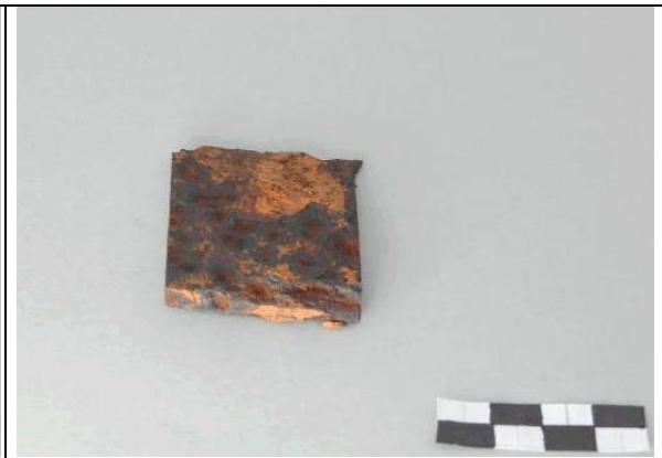
Foto 66: Fragment Sax P7 – Rückseite, 3,4µm Parylen C beschichtet [Jückstock 2011, S.53]
