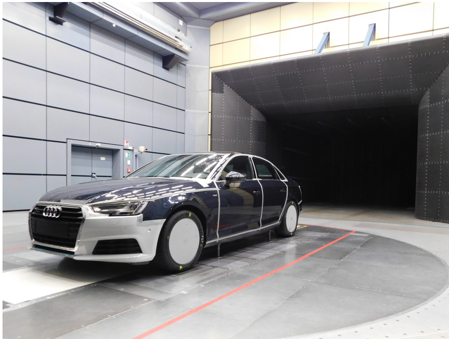
Abbildung 2.3: Versuchsfahrzeug Audi A4 2,0L TDI Limousine im Audi-Aeroakustik-Windkanal.
