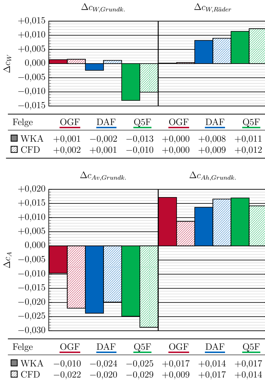
Abbildung 3.17: Vergleich der Felgendeltas der integralen Kraftbeiwerte zwischen Windkanalmessung und CFD-Simulation am DrivAer-Modell mit Stufenheck und Motorraumdurchströmung. Die GGF-Felge dient als Referenz.
