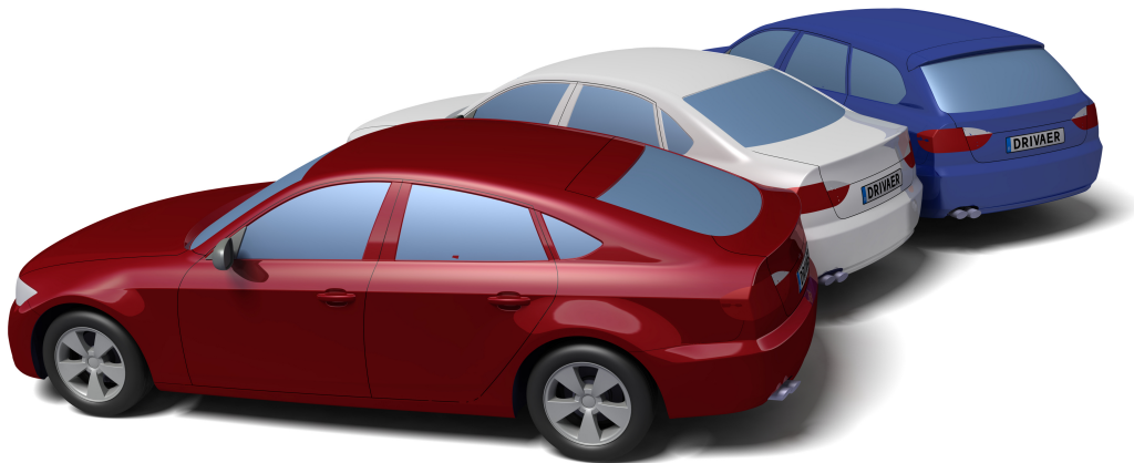
Abbildung 2.2: DrivAer-Referenzfahrzeuggeometrie mit den drei unterschiedlichen Heckformen Fließheck (rot), Stufenheck (weiß) und Vollheck (blau) (Collin et al. (2016)).
