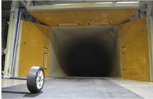
Abbildung 2.1: Messaufbau für das isolierte Einzelrad im Windkanal.
