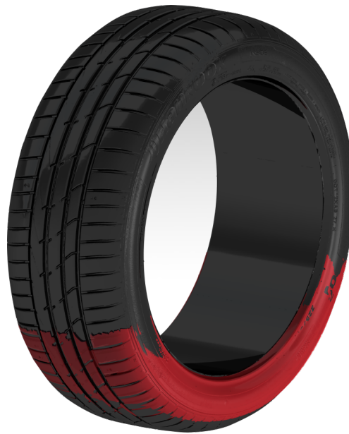
Abbildung 4.15: CAD-Modell des optisch vermessenen unverformten Reifens (schwarz) und der statischen Radlatschverformung (rot) zur Berücksichtigung im Simulationsmodell.
