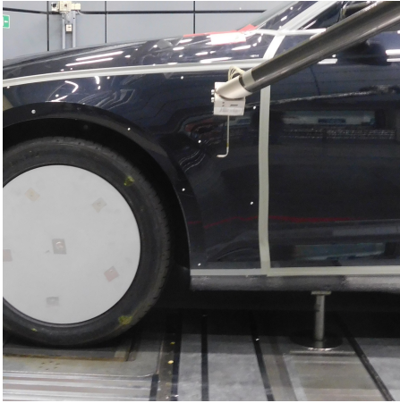
Abbildung 2.9: Versuchsaufbau der Mehrlochsonde im AAWK.
