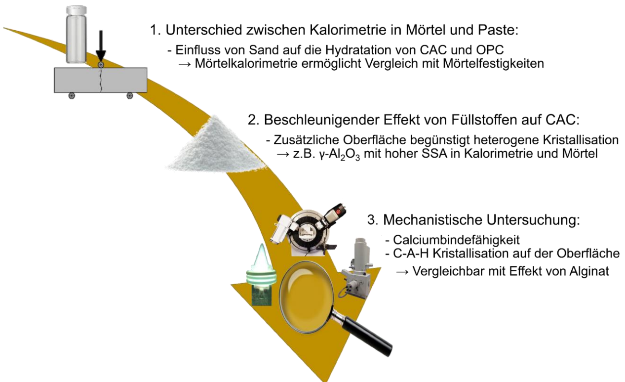
Abbildung 30: Vorgehensweise bei der Untersuchung zur beschleunigenden Wirkung von Sand und feinen Füllstoffen ( Publikation 4 ).
