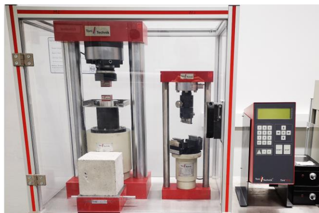
Abbildung 19: Schematischer [155] und instrumenteller Aufbau für die Bestimmung von Druck- und Biegezugfestigkeit eines Mörtels.
