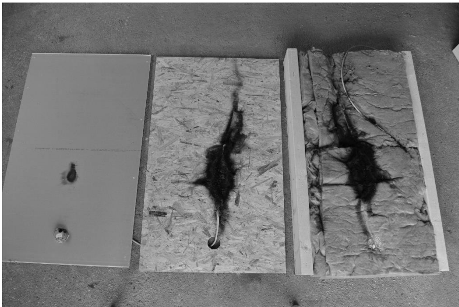
Abbildung 6 Prüfkörper mit mittig verlegtem PVC-Kabel nach Öffnung und Lichtbogeneinwirkung [3]
