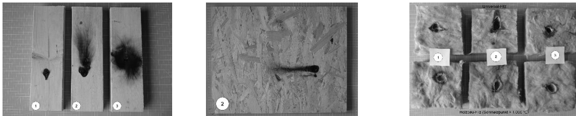
Abbildung 3 Prüfkörper nach Versuch (v.l.n.r.): KVH, OSB und Dämmung [3]
