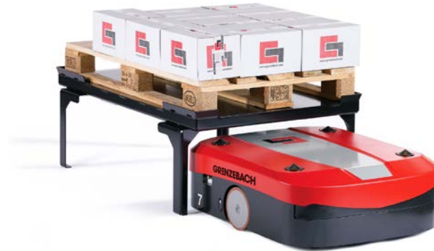
Abbildung 2-3: Unterfahr-FTF L600 der Firma Grenzebach [Quelle: Grenzebach Maschinenbau GmbH].
