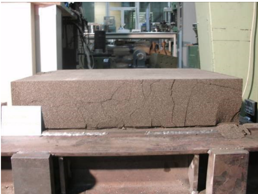
Abbildung 4-7: Schaumglasblock mit vertikalen Rissen aufgrund von Biegebelastung
