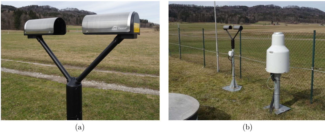
Abb. 4.5: Meteorologische Instrumente auf dem Testgelände in Fendt: (a) Distrometer 1 bei dem Reflektor und (b) Distrometer 2 in der Nähe des Millimeterwellen-Instruments.
