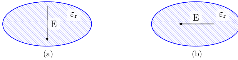
Abb. 2.10: Darstellung eines Tropfens mit zwei orthogonalen Polarisationen der elektrischen Feldstärke: (a) Tropfen mit vertikal polarisierter Welle und (b) Tropfen mit horizontal polarisierter Welle.
