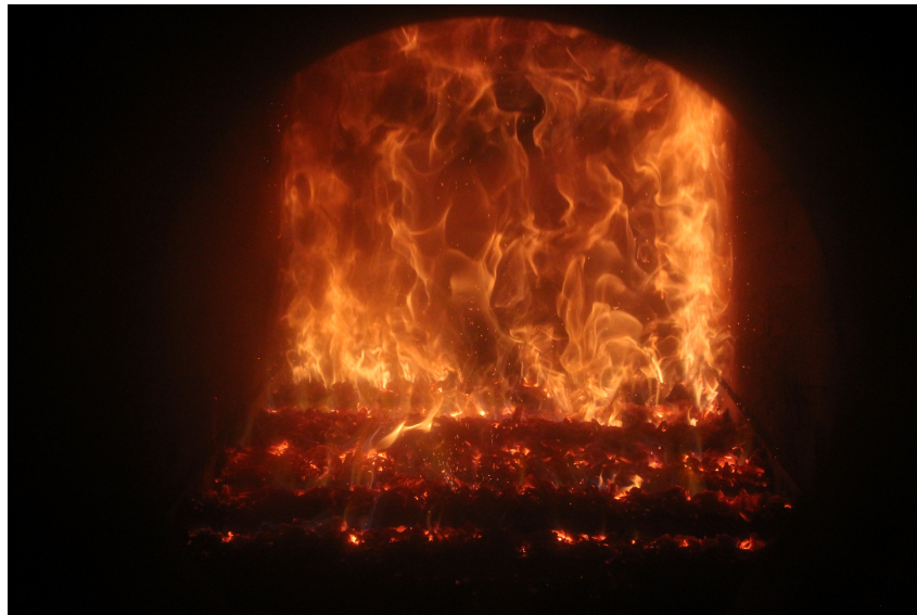
Abbildung 2.5: Momentaufnahme einer Feuerung mit Vorschubrost
