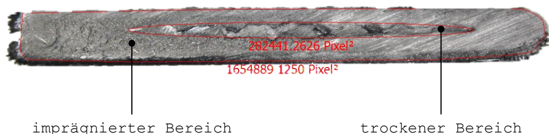
Abb. 3-22: makroskopische Aufnahme des 60x5 mm 2 -Profils im Querschnitt (nach [219])
