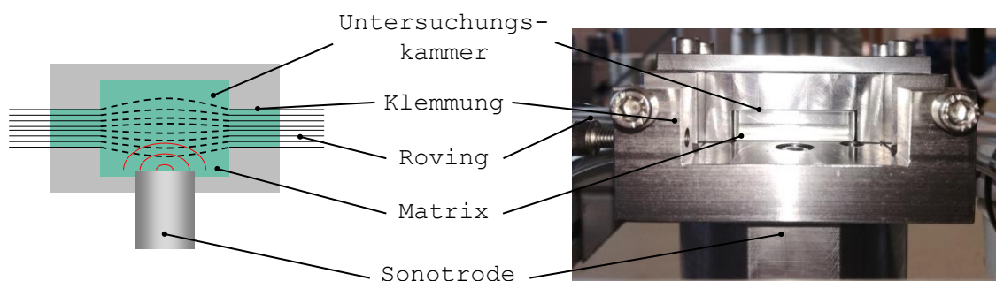
Abb. 3-11: Teststand Aufbauschung: schematische (links) und reale Darstellung (rechts, [190])
