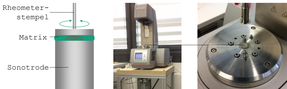
Abb. 3-13: Teststand Viskosität: schematischer Aufbau (links); Integration in das Rheometer (mittig; [189]) und Detailansicht (rechts; [189])
