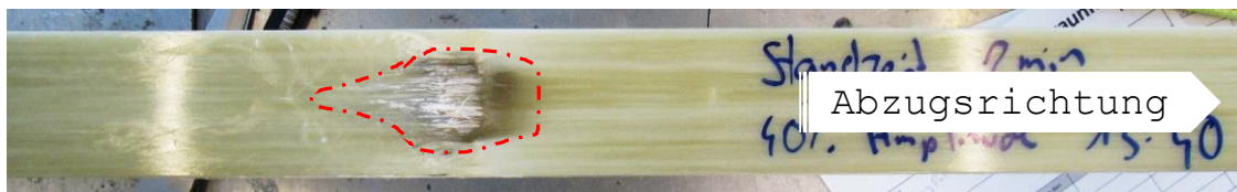
Abb. 4-22: Faser-Matrix-Schädigung durch LUS nach einer 2-minütigen Beschallung [21]
