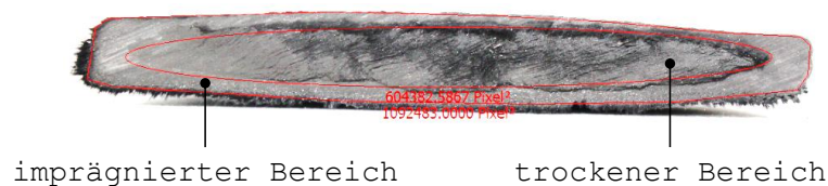
Abb. 4-19: makroskopische Aufnahme der Parametervariation CF_108_TD
