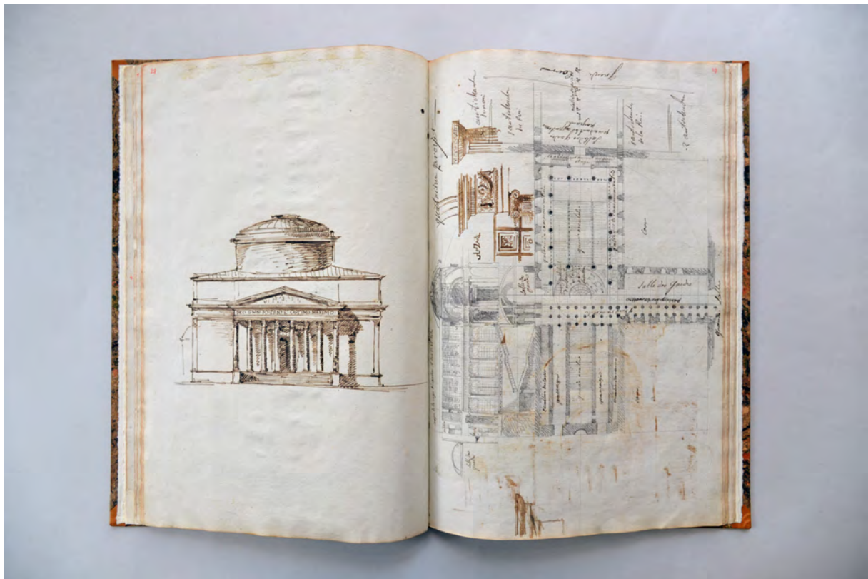
folio 14 verso: Skizze eines Kirchenentwurfes in brauner Tinte; folio 15 recto: Bleistiftskizze in Grundriß und Schnitt zum Treppenhaus in der Residenz, viertes Projekt, mit Detailzeichnungen in brauner Tinte »quatrième projet«
