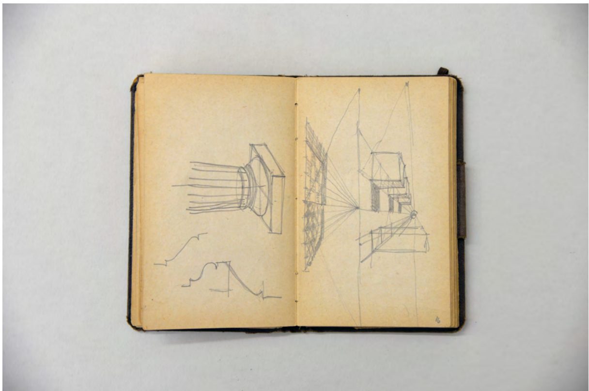
folio 16 verso: räumliche Darstellung eines dorischen Kapitells mit Hilfskonstruktion, Profilschnitte; folio 17 recto: einfache Volumen in Perspektivrasterkonstruktion;
