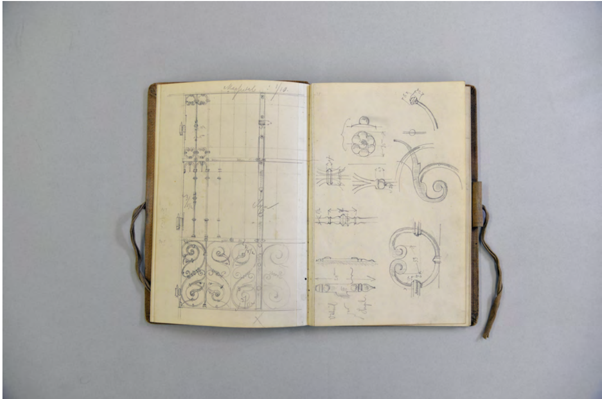
folio 4 verso: Entwurfszeichnung zu einem eisernen Tor »Maßstab 1/10«; folio 5 recto: bemalte Details zu einem eisernen Tor;
