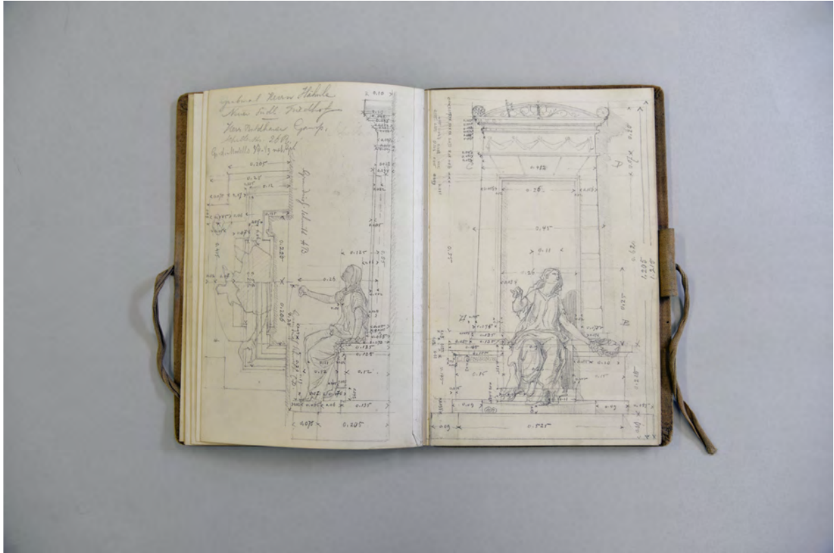
folio 16 verso: Seitenansicht und Grundriß mit genauen Maßangaben »Grabmal Herr Hähle Neuer Südl. Friedhof. Herr Bildhauer Gamp. Schillerstraße 26 R. G. d. Modells 1/4-1/3 nat. Gr.«; folio 17 recto: Frontalansicht mit genauen Maßangaben zum Grabmal für Herrn Hähle;
