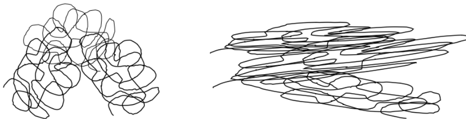
Abbildung 16: Links: Vernetzte Makromoleküle sind ohne mechanische Belastung geknäult und ineinander verhakt. Rechts: Bei mechanischer Belastung werden die Knäuel gezerrt, dadurch erhalten Sie mehr Orientierung und Verhakungen werden teilweise gelöst. Bei dieser Zerrung (Fließvorgang) wird eingetragene Energie teilweise in Wärme umgewandelt und geht verloren. 36
