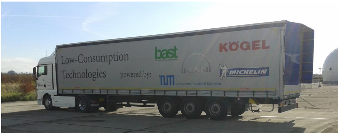
Abbildung 4.6: Funktionsprototyp eines Heckeinzugs am Sattelanhänger des Testfahrzeugs
