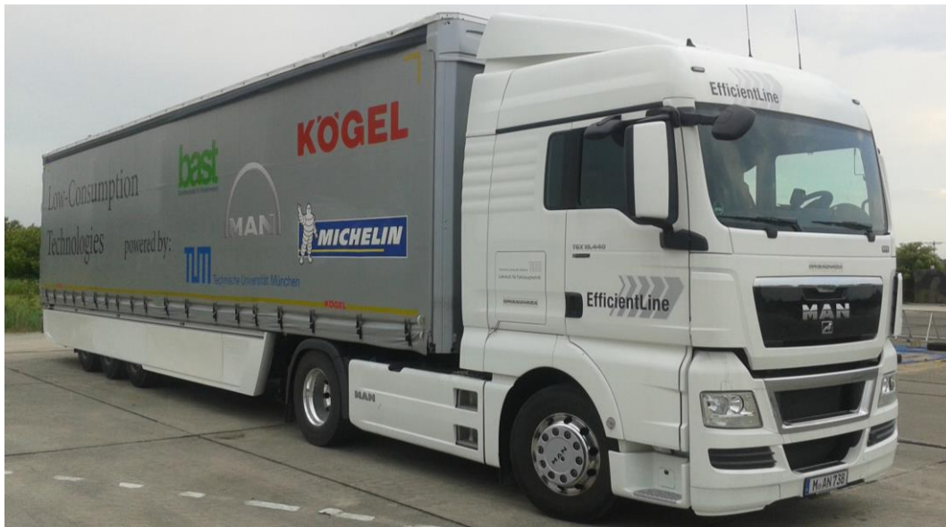
Abbildung 4.4: Seitenverkleidung mit vertikalem Flügelprofil an der Vorderkante, montiert am Sattelanhänger des Testfahrzeugs
