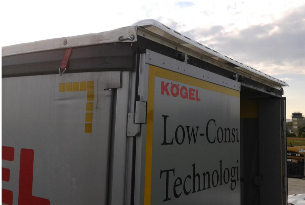
Abbildung 4.3: Umlenkschaufeln „SDR-Diffusor“ am Sattelanhängen des Testfahrzeugs
