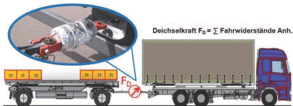
Abbildung 2.12: Schleppversuch zur Ermittlung des Rollwiderstandes nach Bode und Bode [32, S. 20]
