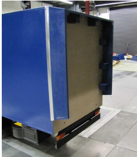
Abbildung 4.2: Heckeinzugsklappen, Windkanalmodell 1:2,5 [36, S. 50] Geometrie in Originalgröße 1:1: Länge 400 mm, Einzugswinkel 13 °, Bodenfreiheit 1,5 m, Radius der Kantenrundung zwischen oberer und seitlicher Klappen 25 mm
