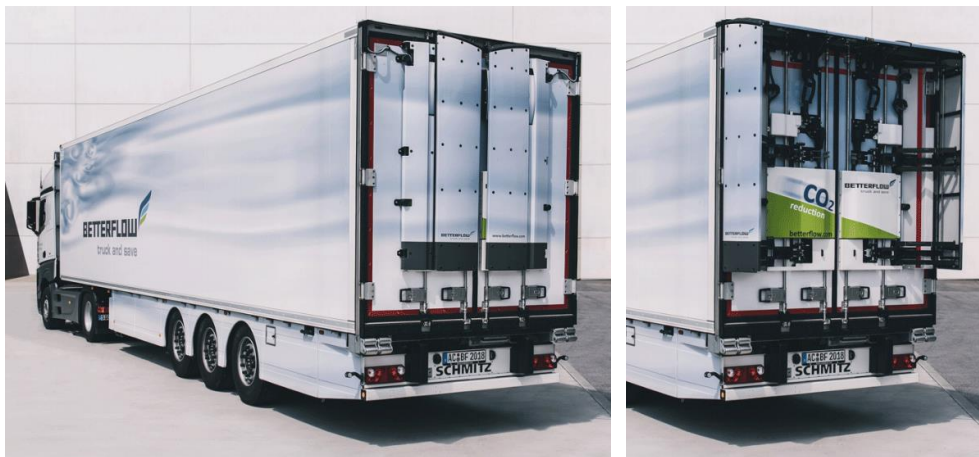
Abbildung 4.1: Heckenzugklappen im ein- und ausgefahrenem Zustand [70]
