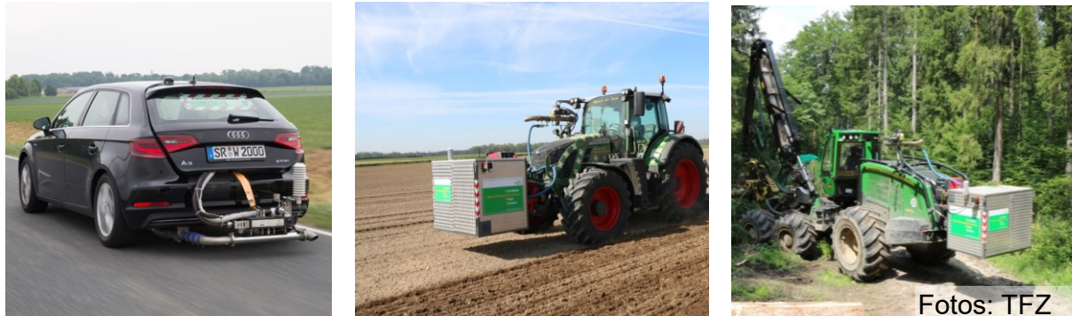
Abbildung 7: Portables Emissionsmesssystem (PEMS) an einem PKW, Traktor und Holzvollernter
