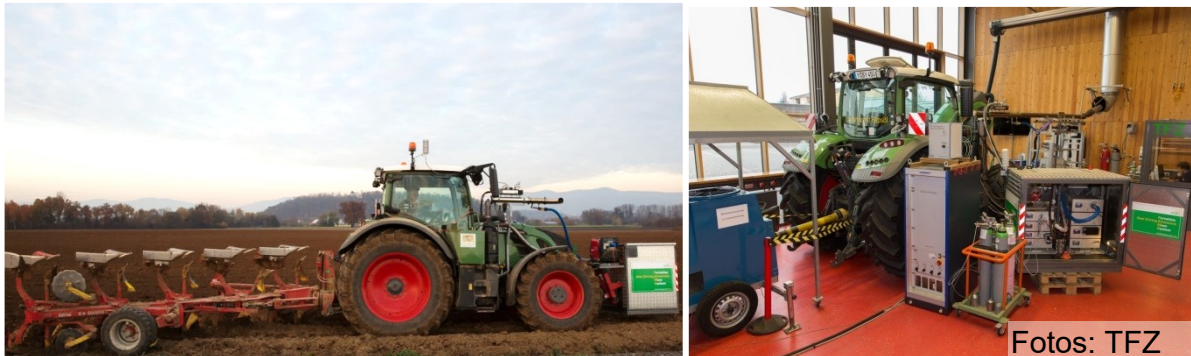
Abbildung 22: Emissionsmessung im Feld und am Traktorenprüfstand
