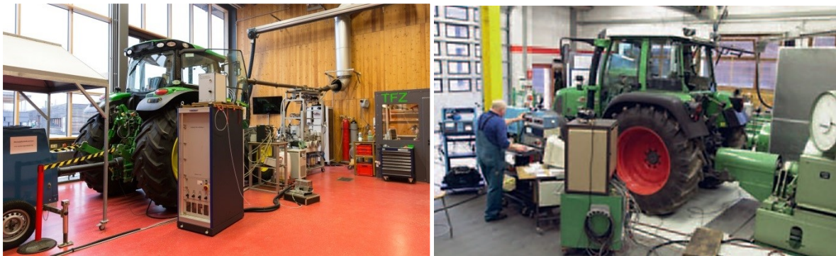
Abbildung 4: Traktorenprüfstand mit einer Wirbelstrombremse an der Traktorzapfwelle (Foto: TFZ, links; Agroscope, rechts [97])
