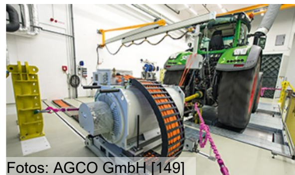
Abbildung 6: Gesamtfahrzeugprüfstand für Traktoren der AGCO GmbH (nach RÜCKERT et al. (2015) [149])
