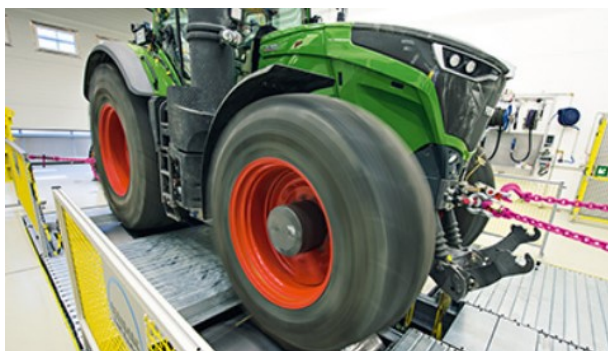
Abbildung 6: Gesamtfahrzeugprüfstand für Traktoren der AGCO GmbH (nach RÜCKERT et al. (2015) [149])
