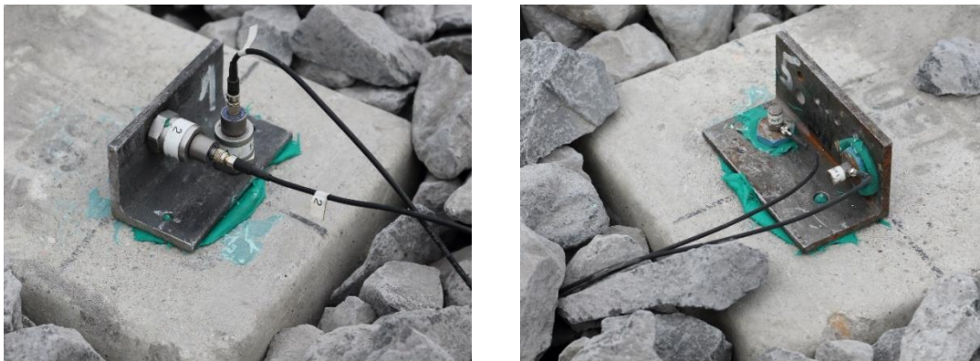
Abbildung 50: Beschleunigungsaufnehmer links: Bruel&Kjaer 4370, rechts: Bruel&Kjaer 4397A
