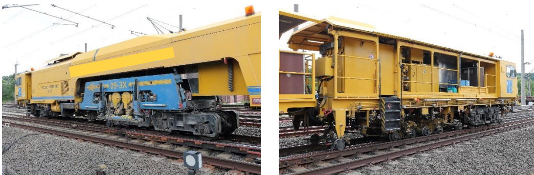
Abbildung 3: Gleisbaumaschine 09-3X-Dynamic, links - vorderer Teil Stopfmaschine; rechts - hinterer Teil DGS
