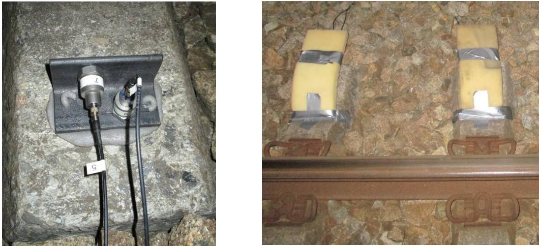
Abbildung 43: links - Beschleunigungssensor; rechts - Schutz der Messtechnik
