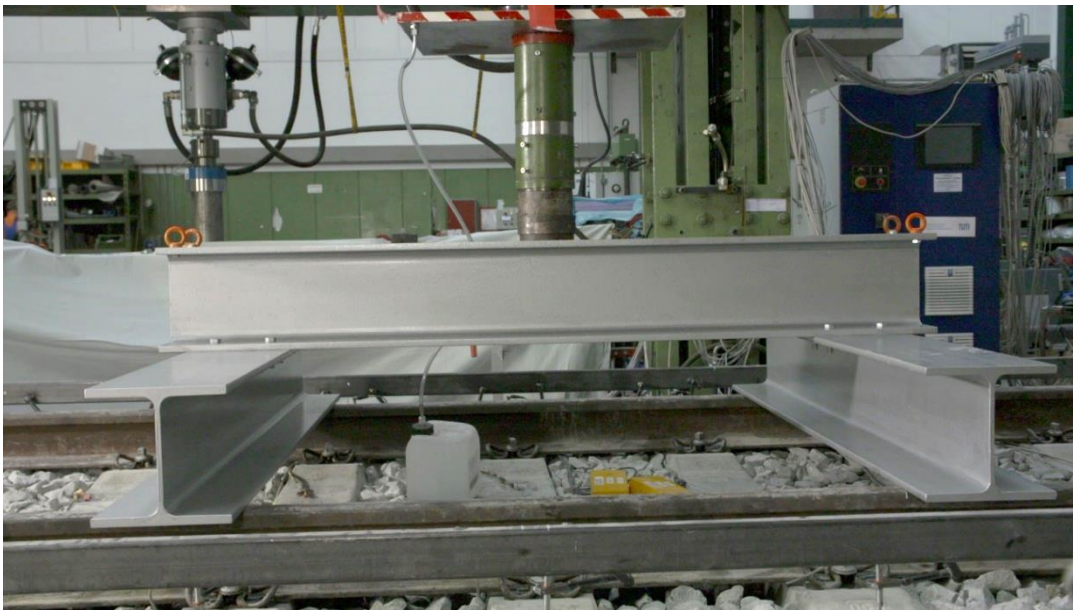
Abbildung 57: Belastungsrahmen für Verkehrsbelastung
