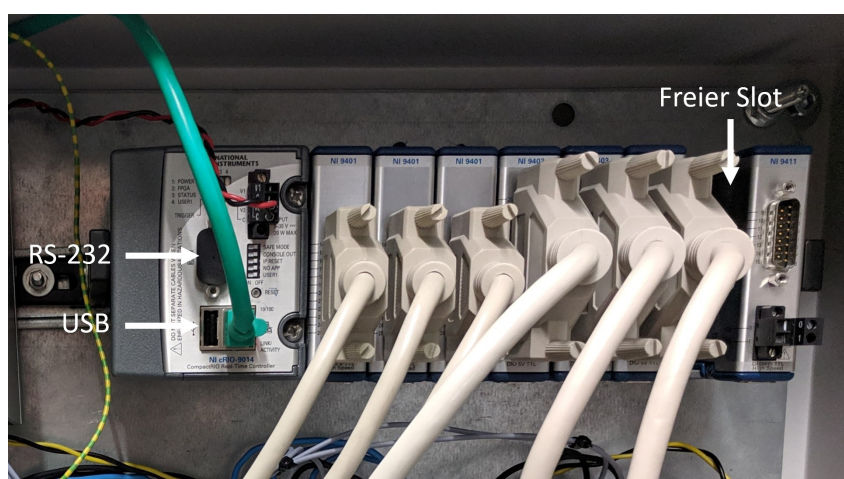
Abb. 3–17: Anschlussmöglichkeiten des CompactRIO 9014-Systems
