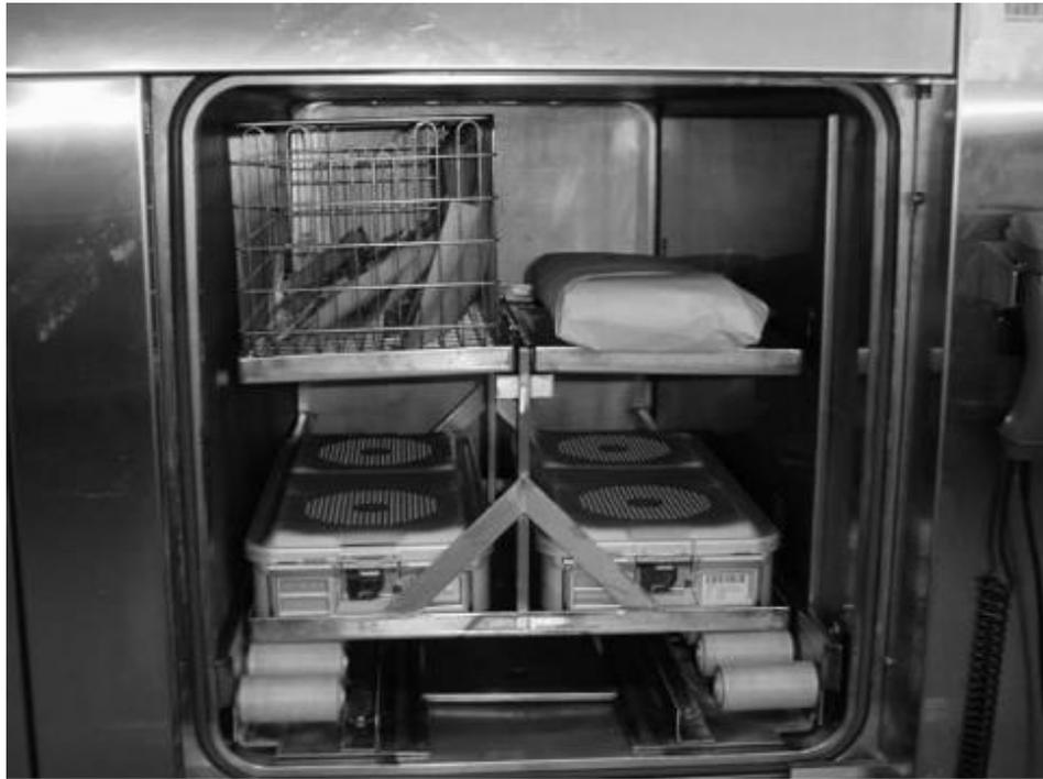
**Abbildung 16: Bestückter Dampfautoklav (Liehn u.a. 2006)**
