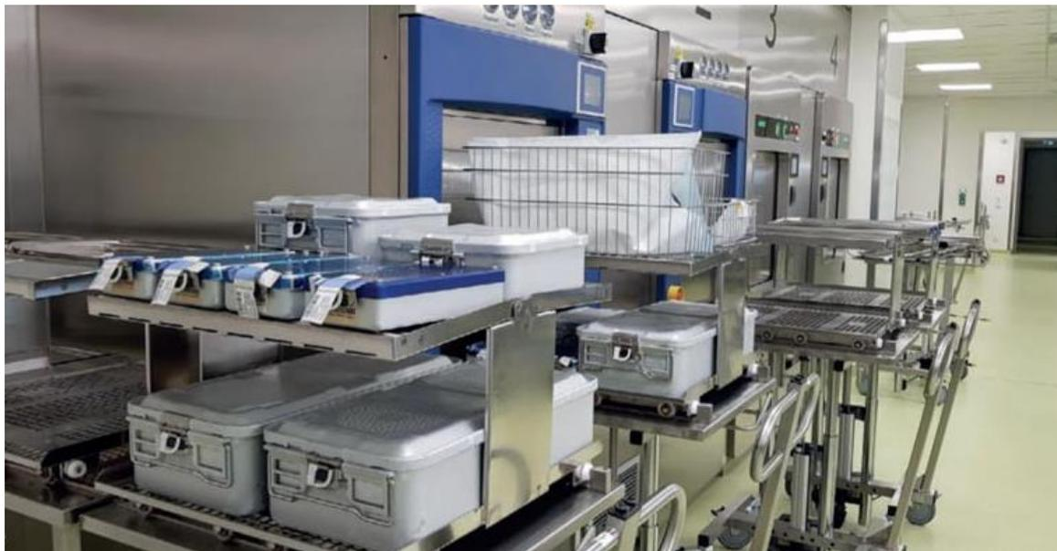
**Abbildung 17: Instrumentencontainer vor dem Dampfsterilisator (Scholl und Wagenhäuser 2019)**
