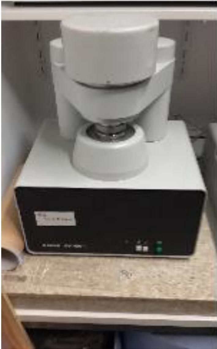
**Abbildung 43: Viskosimeter Haake RV 100**
