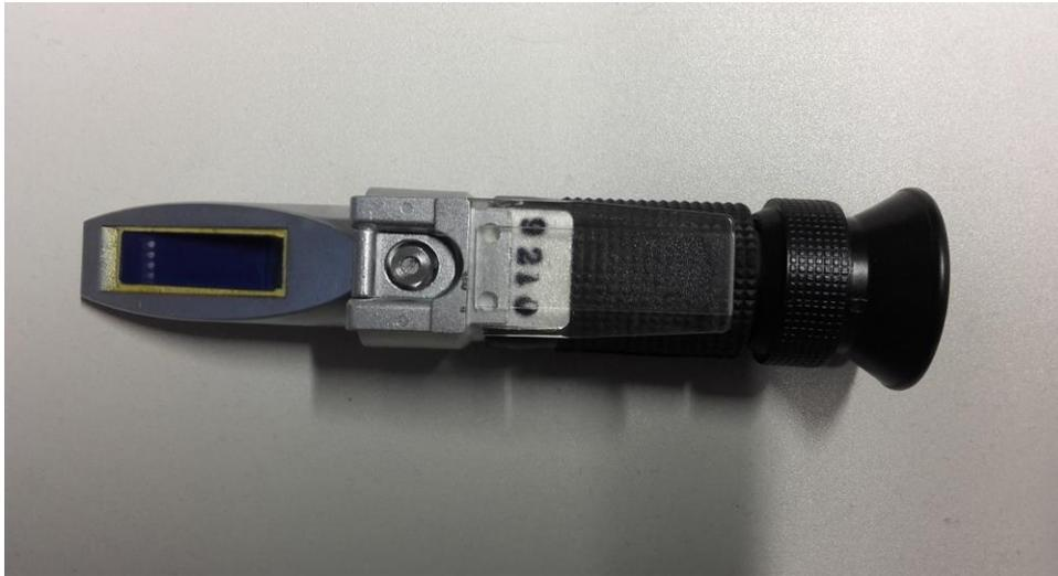
**Abbildung 27: Refraktometer**
