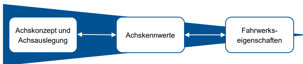
Abbildung 1.3: Achskennwerte zur Bewertung der Eigenschaften des Fahrwerks
