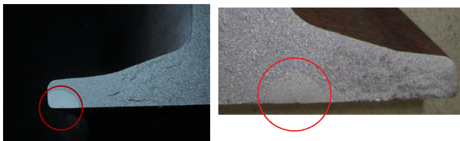
Abbildung 1.1: Risse in Schienenfüßen
