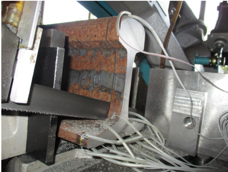
Abbildung 4.2: Sägeschnittverfahren (zweiter Schnitt) aus [Pessel, Mensinger, Simon et al., o.D.]
