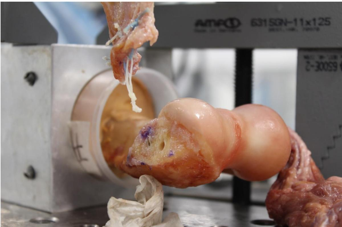
**Abb. 41:** „SR“, Fadenabriss aus Schraube
