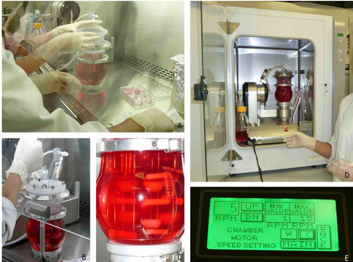
Abbildung 20: Aufbau Bioreaktor. A) Einsetzen der durchgestochenen TECs. B) Zuschrauben des Gefäßes. C) Bioreaktorgefäß mit Scaffolds. Zu erkennen sind die Nadel, an denen die TECs fixiert sind. Das Gefäß ist mit Nährmedium gefüllt. D) Der Bioreaktor ist in einem Brutschrank installiert. E) Bioreaktor-Einstellungen auf dem Display. (Eigene Darstellung)
