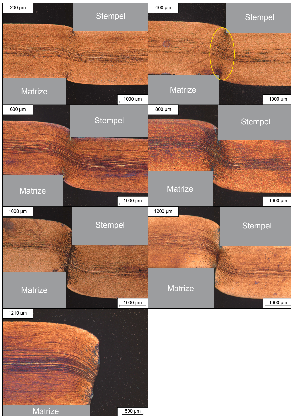
Abbildung 8.5: Anschnittfolge in Schritten von 200 µm für den Werkstoff 1.4301 Schneidparameter: L120 | R10 | S15 | K0
