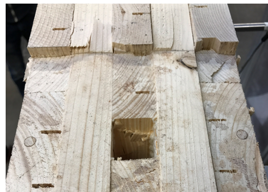
(b) Schub/Querdruckversagen der Querlagen
