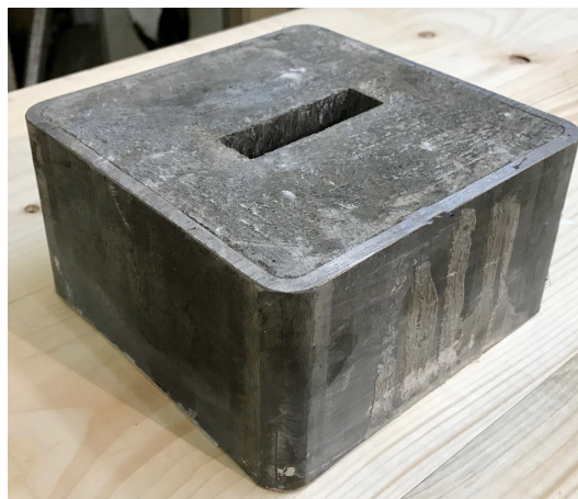
Abbildung 6.4: Hybridankerplatte aus UHPC
