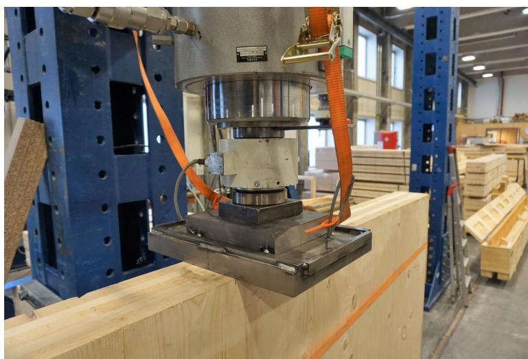
Abbildung 7.18: Hydraulikzylinder und Lasteinleitung
