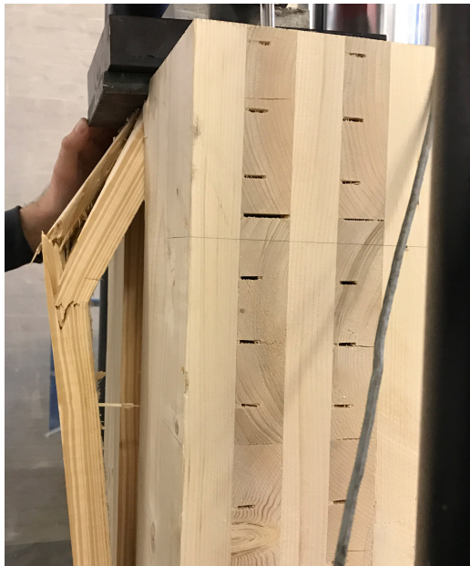
(a) Ausknicken einer Decklamelle
