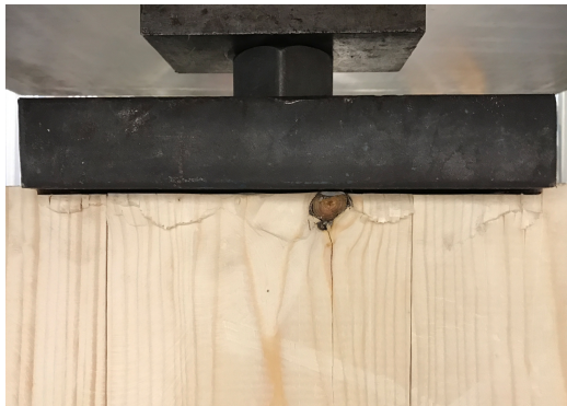
(a) Druckfalte direkt unterhalb der Lasteinleitung
