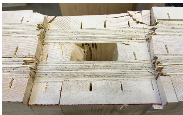
Abbildung 6.10: Typisches Bruchbild eines Versuchskörpers der Serie D
