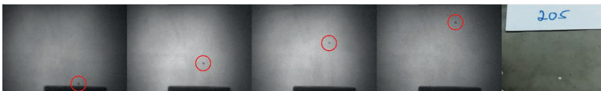
Abb. 14: Hochgeschwindigkeitsaufnahmen eines Tongranulatpartikels (Catsan®) mit einer Korngröße zwischen 450\ \mu\text{m} und 560\ \mu\text{m} bei einer Geschwindigkeit von ungefähr 200\ \text{m/s}
