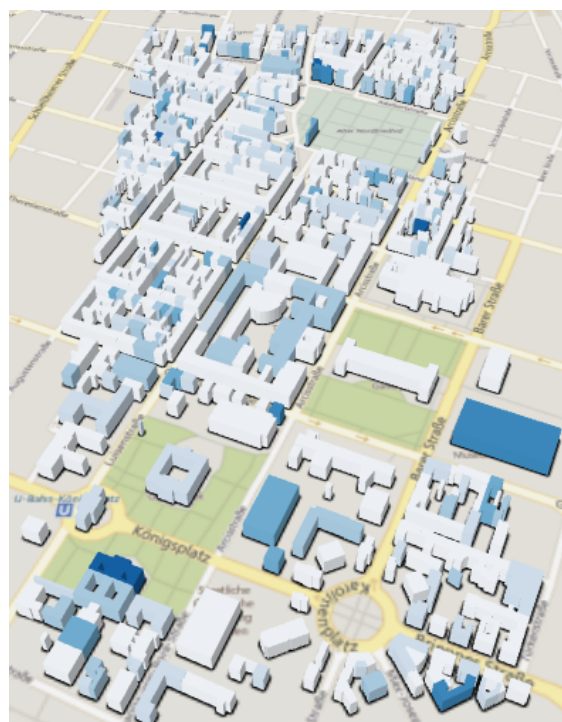
(d) WA-based fusion of TanDEM-X raw DEMs
