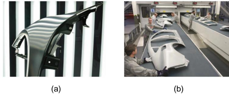
Abbildung 2.7: Anwendung des Streifenlichts auf Außenhautbauteile (a) und Anwendung von Lichtsegeln in der Serienproduktion (b) (Birkert, Haage und Straub, 2013, S. 107)
