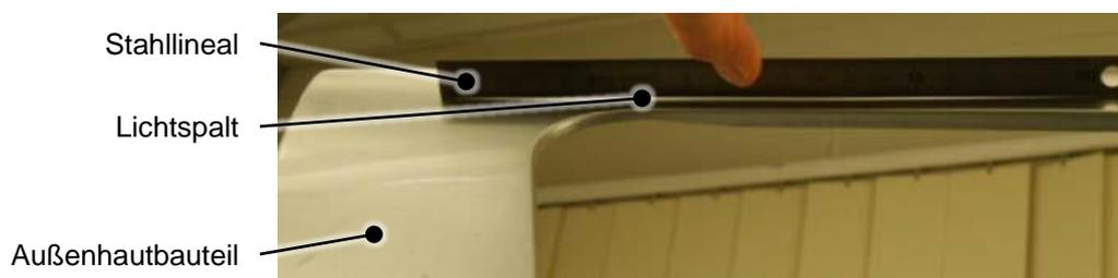
Abbildung 2.8: Anwendung eines Stahllineals zur Detektion einer Einfallstelle anhand eines Lichtspalts nach (Le Port, Thuillier und Manach, 2009, S. 216)
