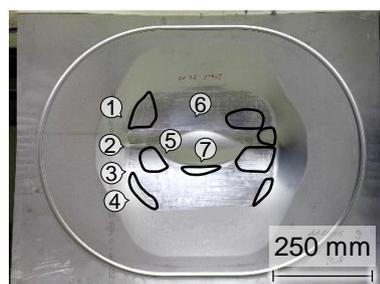
Abbildung 7.5: Bauteil des Werkstoffs AA6016 mit einer Walzrichtung von  $90^\circ$ , welches mit einem Abziehstein der Länge von 250 mm abgezogen wurde
